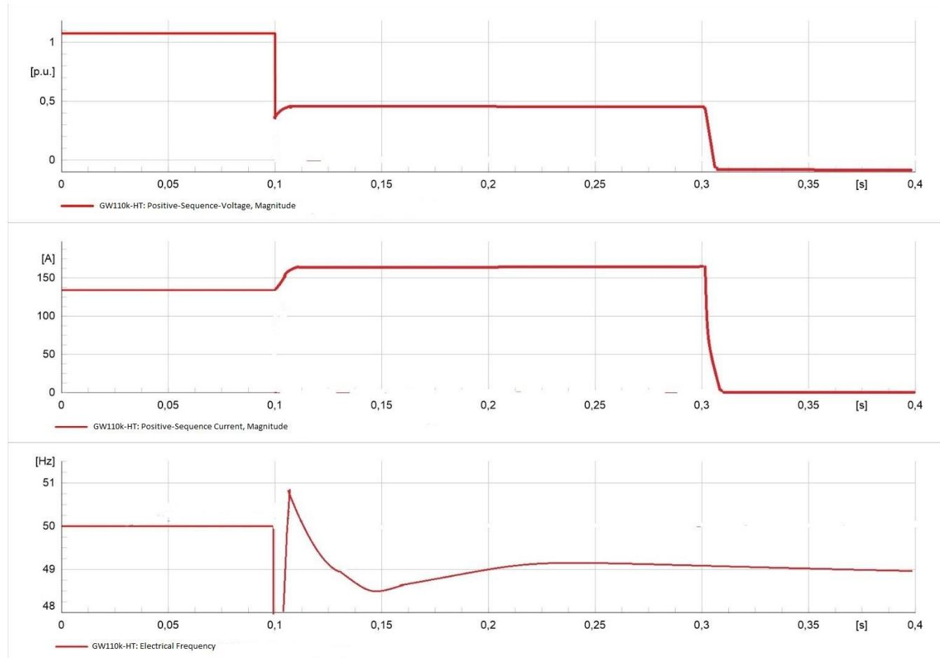
Slika 5.28. Vrijednosti napona, struje i frekvencije na izmjenjivaču 1
