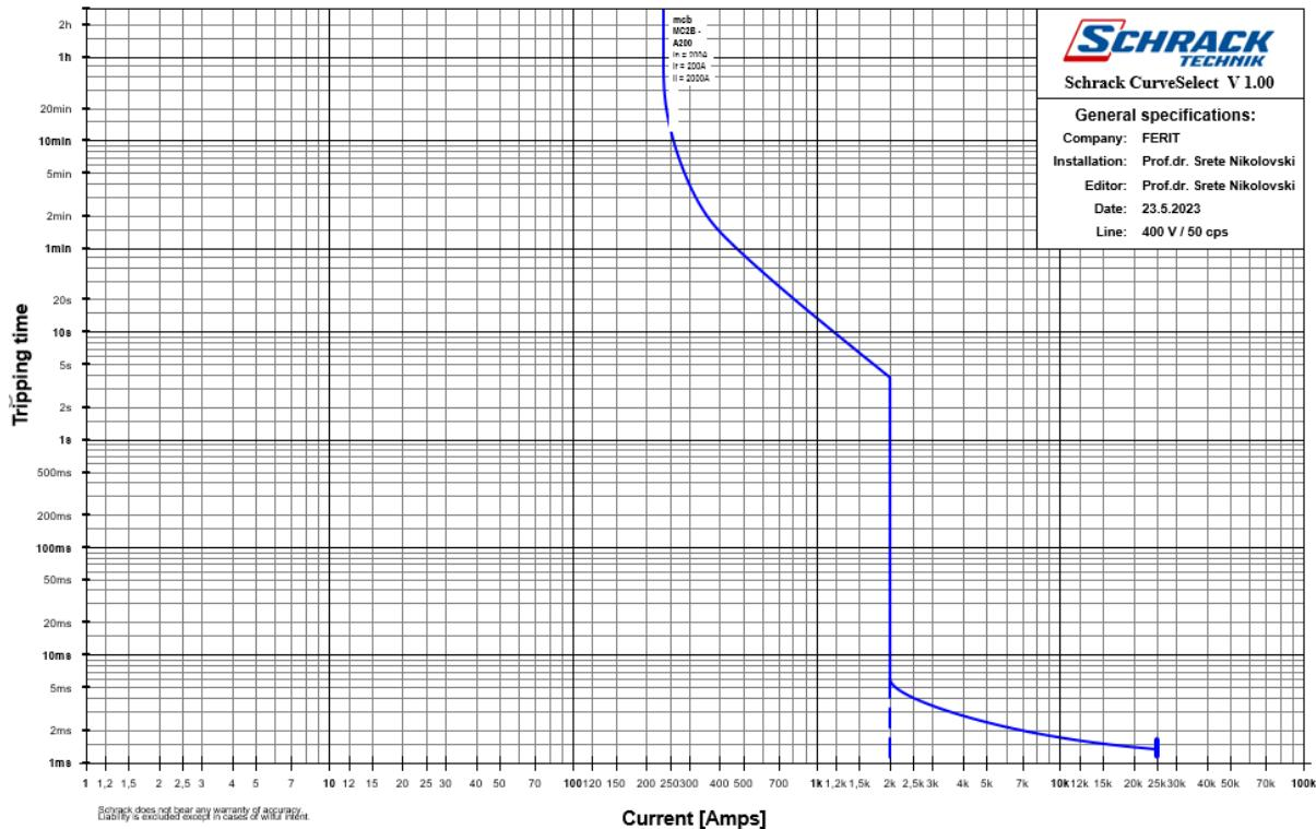
Slika 4.9. karakteristike prekidača Schrack MCB 200 A
