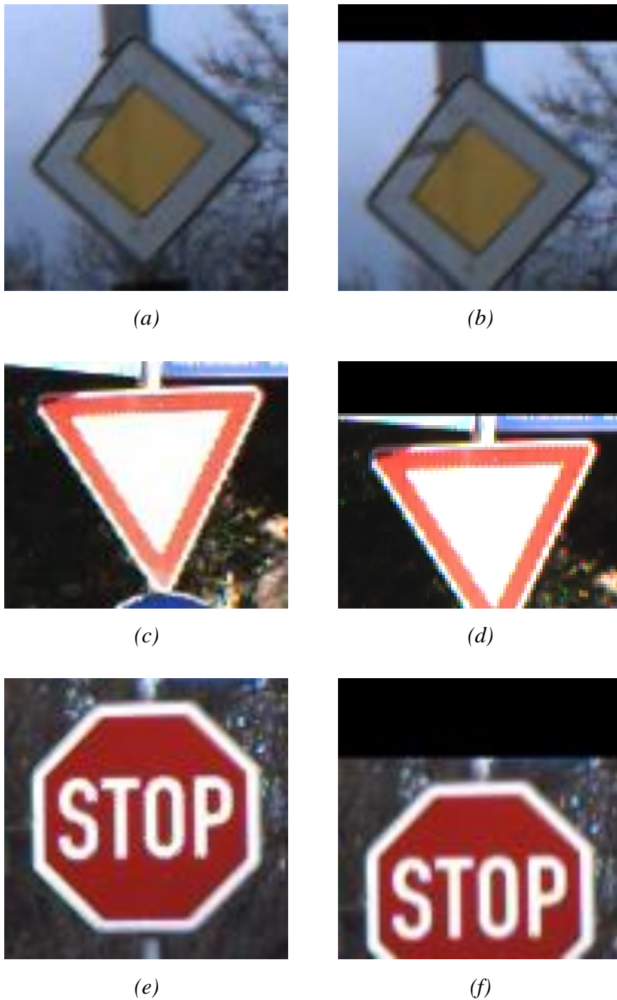
Slika 5.4. (a, c, e) Originalne slike; (b, d, f) Slike nakon primjene augmentacije „Translate Y“ s parametrima (10, 40).
