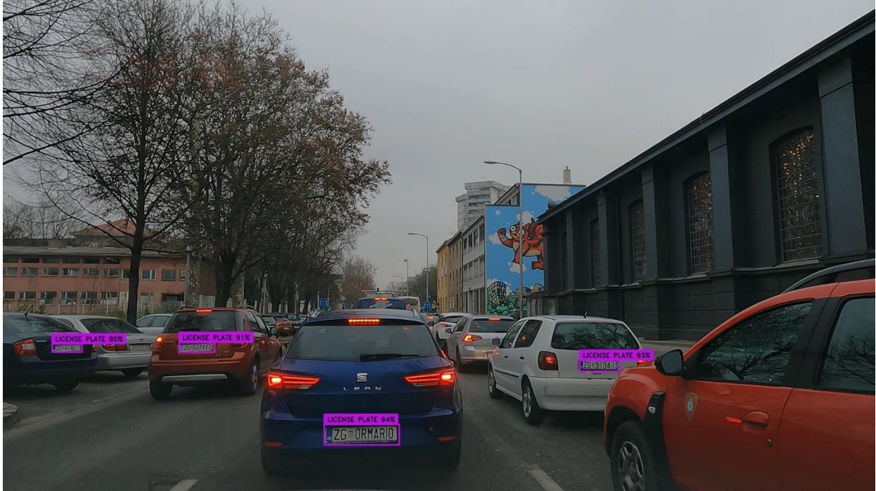
Slika 3.24. Detekcije graničnih okvira registarskih tablica vozila bez filtriranja na one koje se nalaze unutar područja ispred vozača
