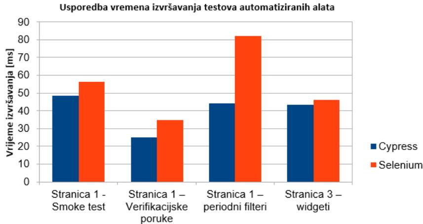
*Slika 6.10. Graf usporedbe vremena izvršavanja testova automatiziranih alata*
