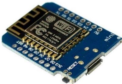
Sl. 3.4. ESP8266 mikroupravljačka pločica (WeMos D1 mini). [10]
