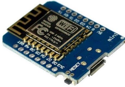
Sl. 3.4. ESP8266 mikroupravljačka pločica (WeMos D1 mini). [10]
