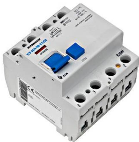
Slika 7.8. FID sklopka 80-4-03/A. S izvedba, za frekventne pretvarače (tip U), Serija BC, Tip A (osjetljiva na pulsne struje), Norma EN 61008
