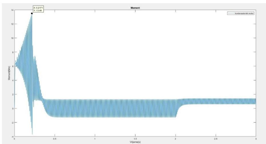
**Slika 4.17.** Moment kondenzatorskog motora s 3 pola
