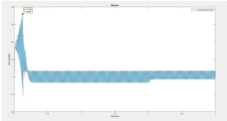
**Slika 4.11.** Moment kondenzatorskog motora pri 220V
