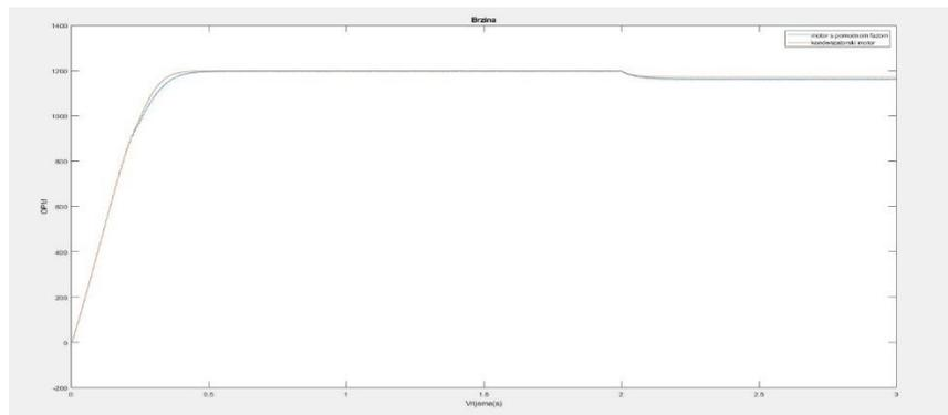
**Slika 4.13.** Brzina motora s pomoćnom fazom i kondenzatorskog motora s 3 pola
