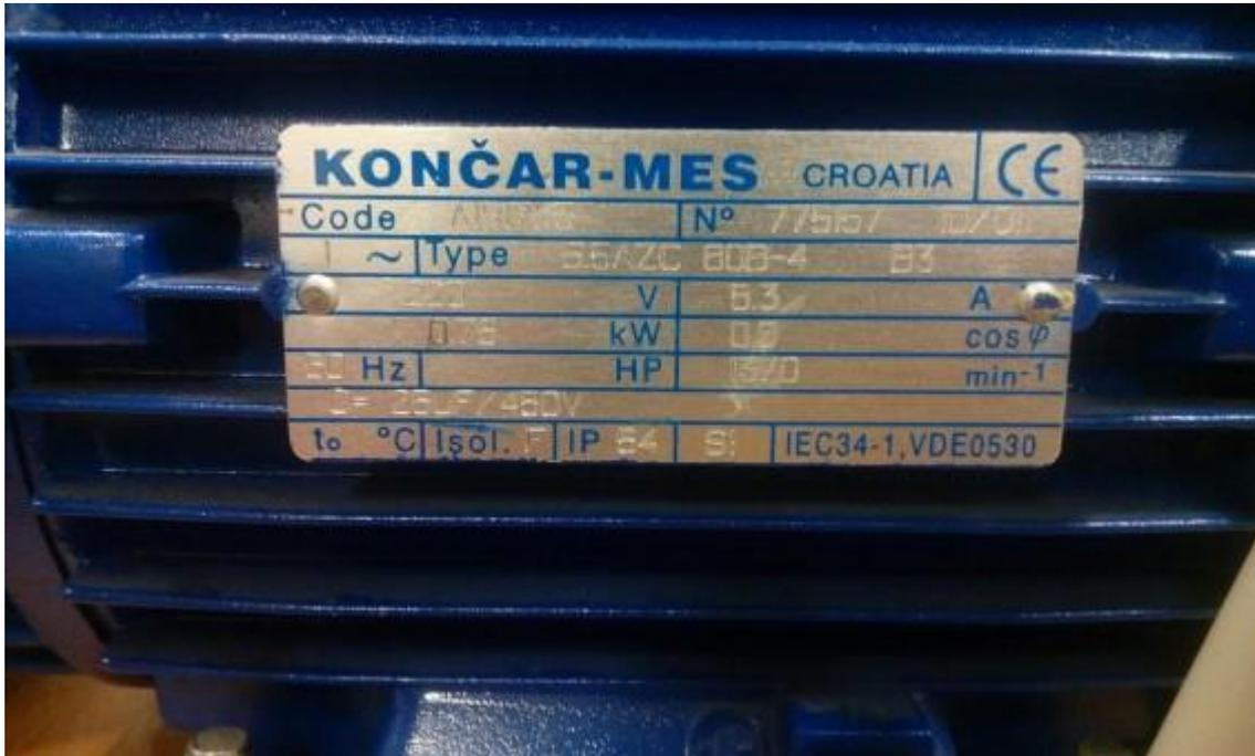
**Slika 2.4.** Nazivna pločica jednofaznog asinkronog motora marke Končar
