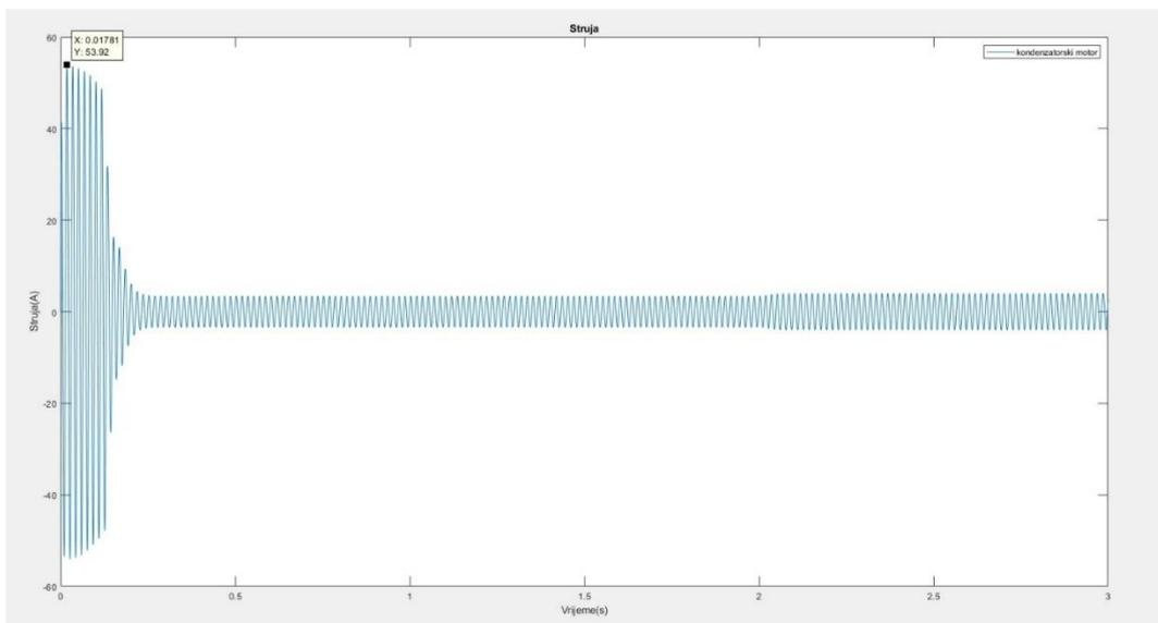
**Slika 4.9.** Struja kondenzatorskog motora pri 220V
