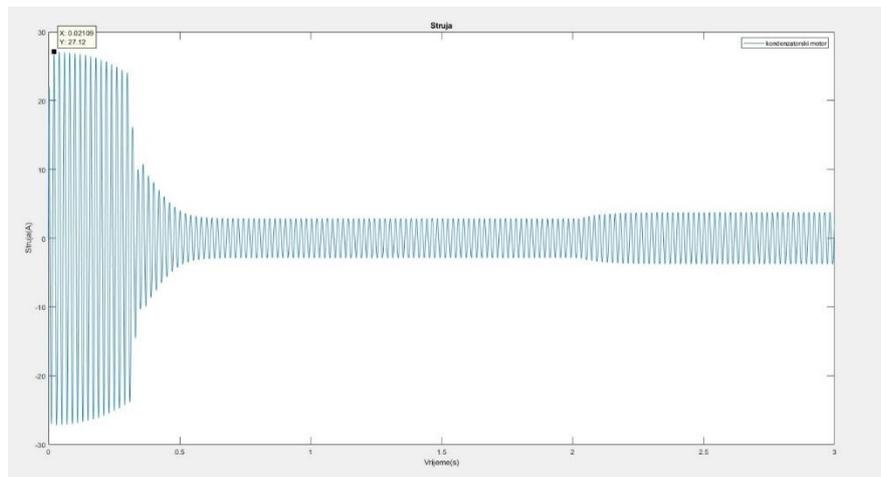
**Slika 4.21** Struja kondenzatorskog motora pri 50 Hz
