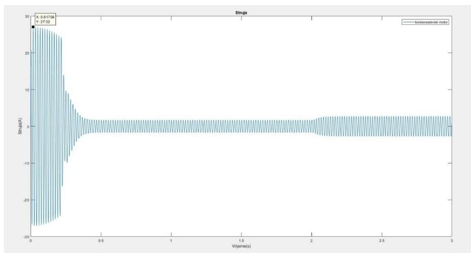
**Slika 4.15.** Struja kondenzatorskog motora s 3 pola
