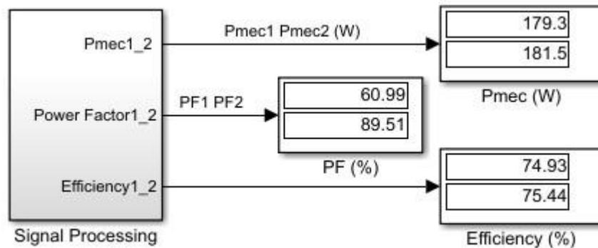
**Slika 4.6.** Mehanička snaga, faktor snage i efikasnost referentnog modela
