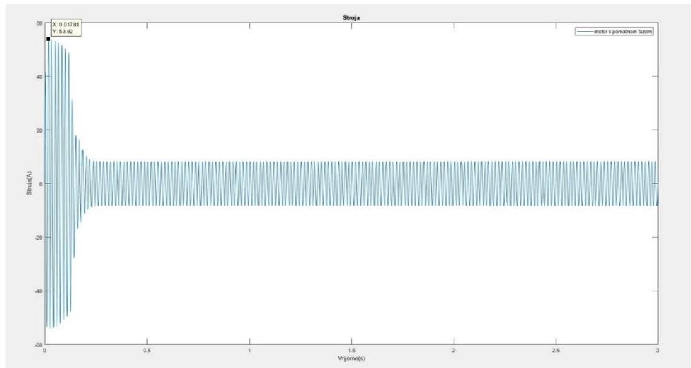
**Slika 4.8** Struja motora s pomoćnom fazom s gašenjem pomoćne faze pri 75% nazivne brzine pri 220V
