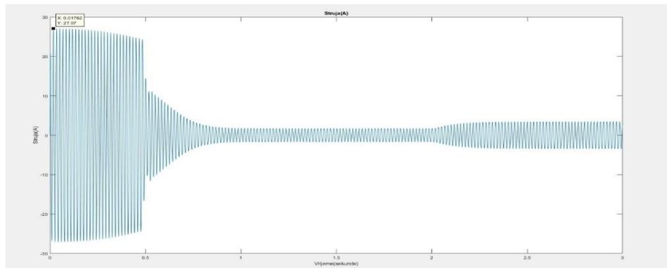
**Slika 4.3.** Struja kondenzatorskog motora na referentom modelu
