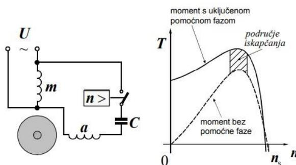
**Slika 2.3.** Shema spoja i karakteristika momenta asinkronog motora[2]
