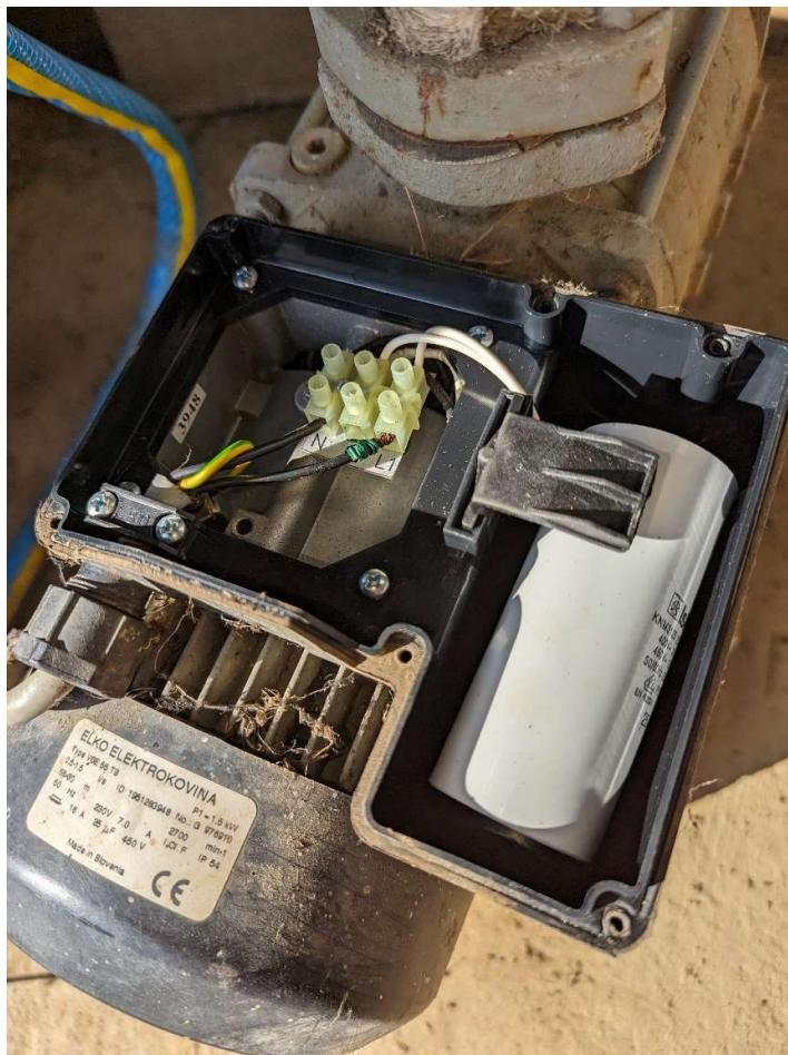
Slika 5.3. Naponske priključnice motora i radni kondenzator
