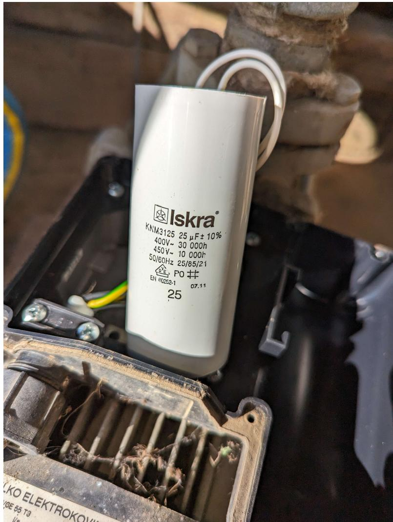
Slika 5.4. Radni kondenzator pogonskog motora
