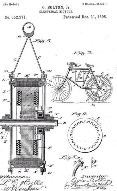
Slika 2.1. Patent za električni bicikl - Ogden Bolton Jr [2]
