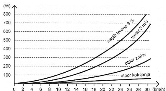
Slika 2.3. Potrebna snaga u ovisnosti brzine [1]
