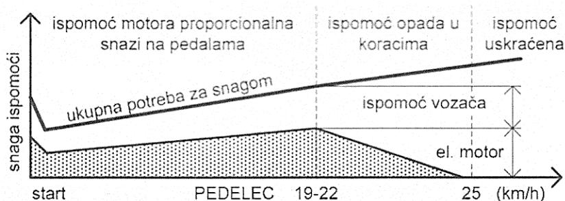
Slika 2.7. Potpora motora u ovisnosti brzine [1]
