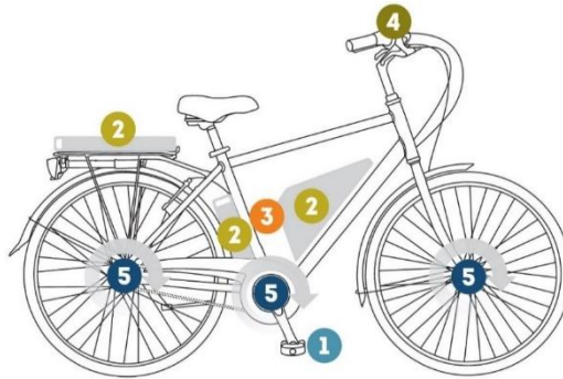
Slika 2.4. Smještaj motora i baterije [5]
