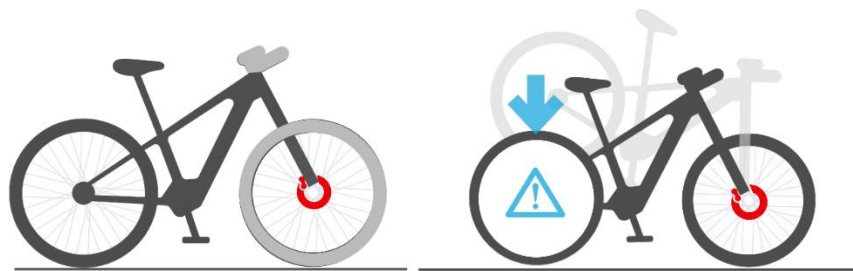
Slika 2.13. Bosch ABS sustav kočenja [19]
