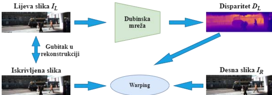
Slika 2.2: Princip treniranja mreže nenadziranim učenjem, ulaz u mrežu je par stereo slika [6]
