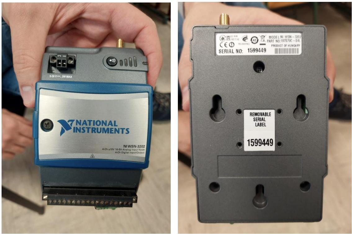
Slika 4.6 Prikaz korištenog NI WSN-3202 uređaja
