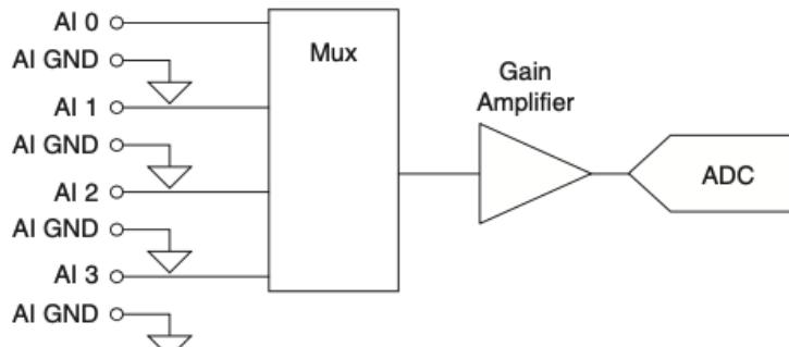
Slika 3.10 Prikaz elektronike uređaja
