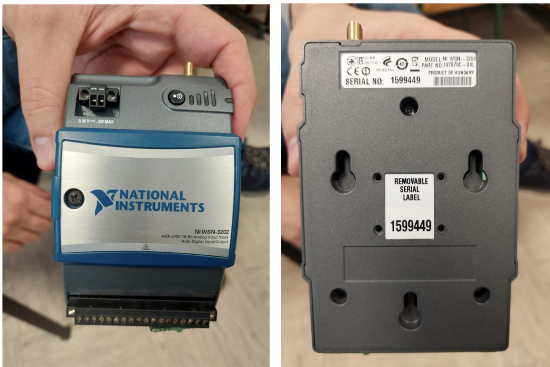
Slika 4.6 Prikaz korištenog NI WSN-3202 uređaja
