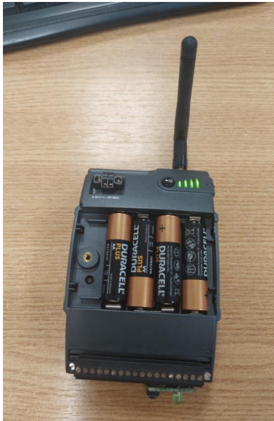
Slika 4.8 Prikaz napajanja uređaja i status povezivanja
