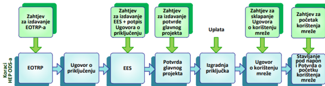
Slika 4.4. Složeno priključenje na mrežu [8]
