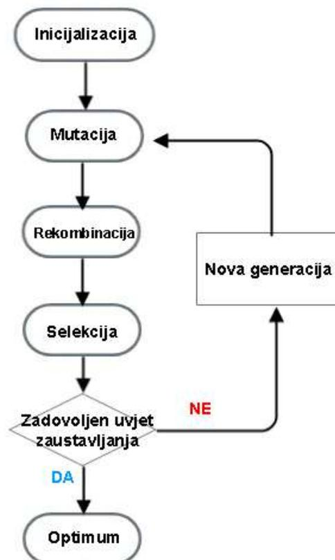
Slika 4.4. Shematski prikaz algoritma diferencijalne evolucije [33]
