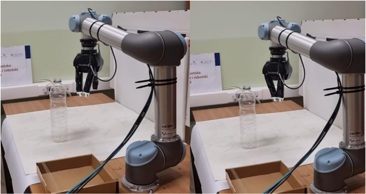
Slika 5.12 Primjer pogrešnog pozicioniranja robotske ruke pri hvatanju objekta
