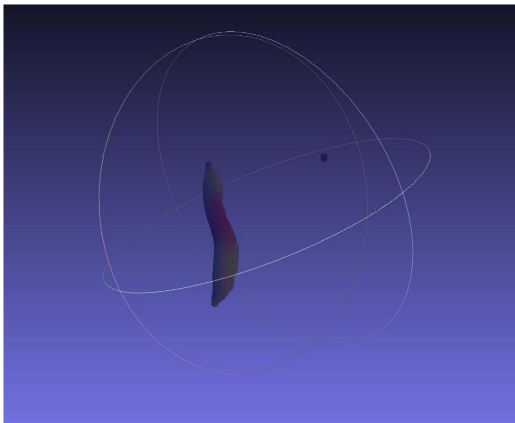
Slika 5.13 Primjer pogrešne rekonstrukcije dijela transparentnog objekta
