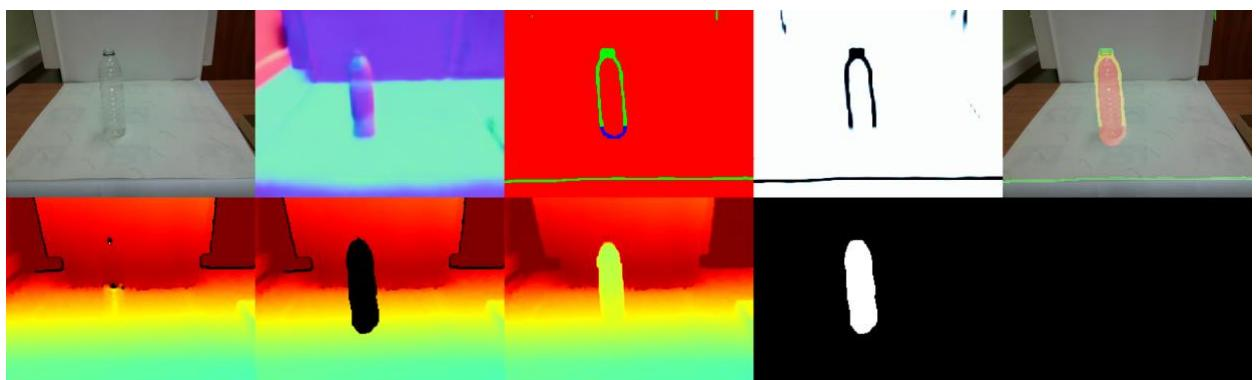
Slika 5.6 Rezultat detekcije transparentnog objekta korištenjem ClearGrasp metode
