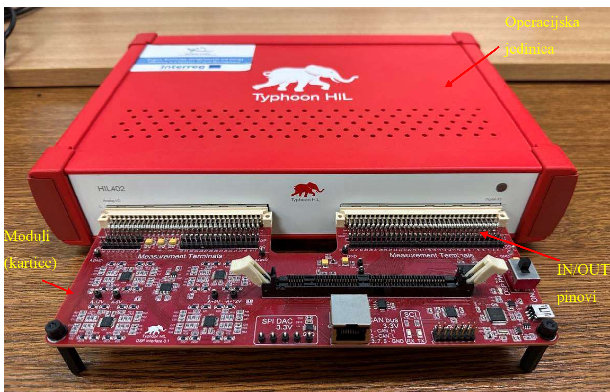
Slika 6.3 Hardverski dio Typhoon HIL-a
