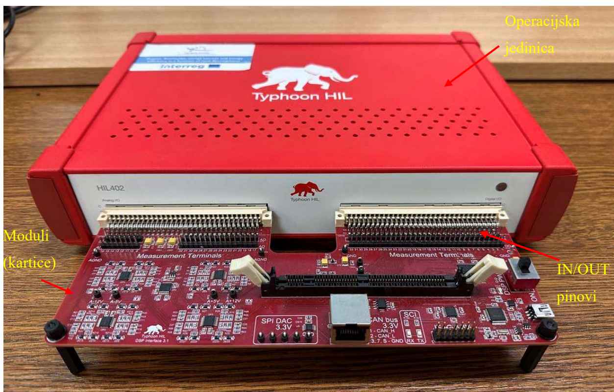
Slika 6.3 Hardverski dio Typhoon HIL-a
