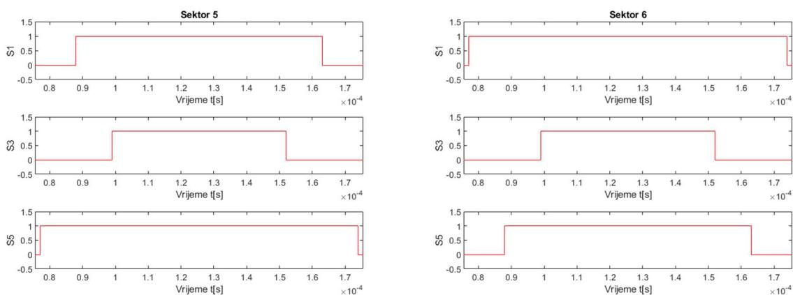
**Slika 5.26** Generirani upravljački signali za peti i šesti sektor,  $f_s = 10 \text{ kHz}$
