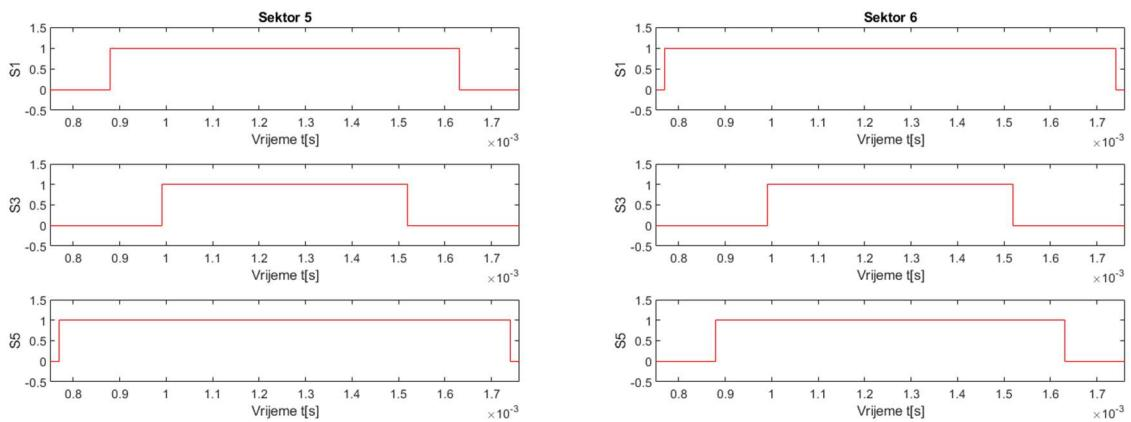
**Slika 5.20** Generirani upravljački signali za peti i šesti sektor,  $f_s = 1 \text{ kHz}$
