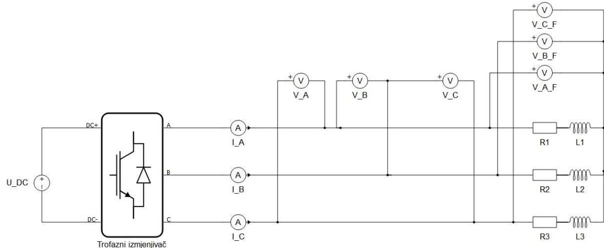
**Slika 6.4** Trofazni izmjenjivač napona u Schematic Editoru
