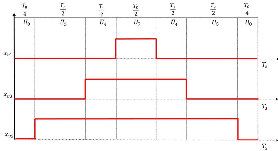
**Slika 4.9** Simetrični obrazac sklapanja ventila za četvrti sektor
