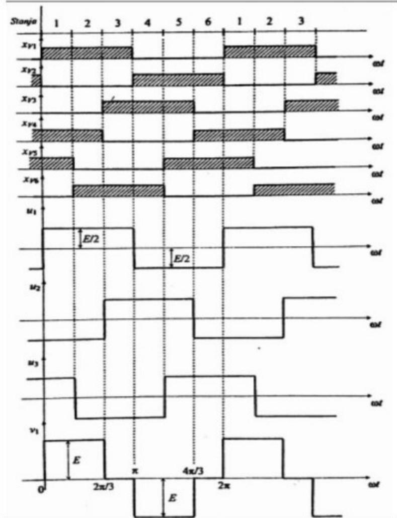
**Slika 3.2** Slijed upravljačkih signala i karakteristični valni oblici napona trošila neupravljenog izmjenjivača [1]
