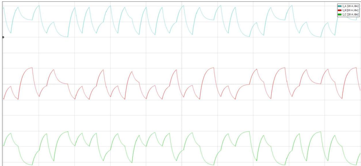
**Slika 6.16** Struje trošila u prvom sektoru,  $f_s = 1 \text{ kHz}$
