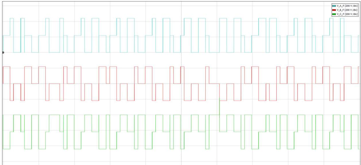
**Slika 6.17** Valni oblik faznog napona u prvom sektoru,  $f_s = 1 \text{ kHz}$
