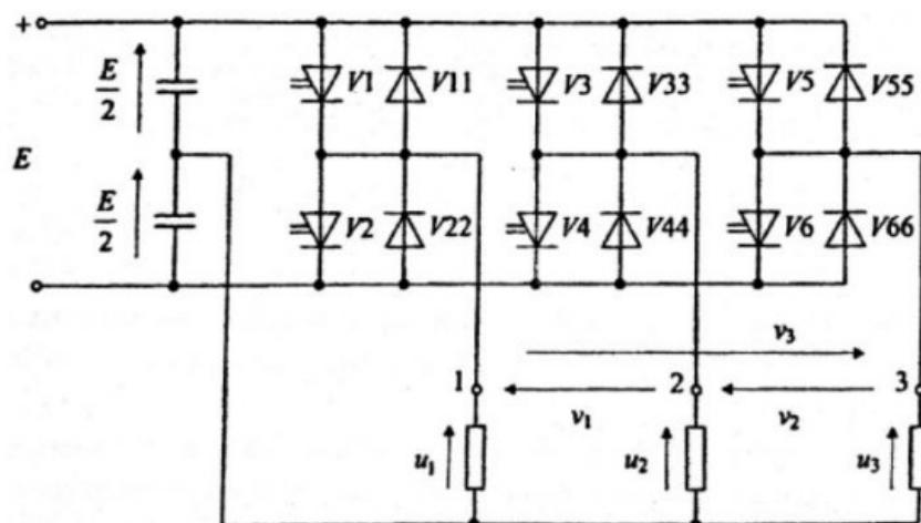
Slika 3.1 Shema spoja trofaznog izmjenjivača s dostupnim zvjezdništem trošila [1]
