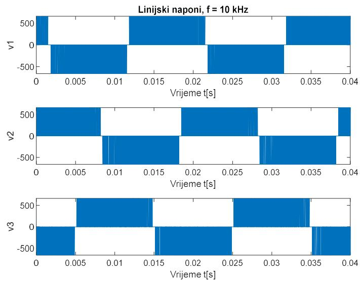
**Slika 5.14** Linijski naponi pri sklopnoj frekvenciji 10 kHz
