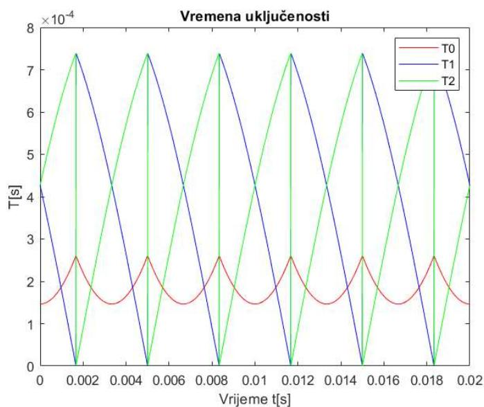
Slika 5.10 Vremena uključenosti vektora  $T_1$ ,  $T_2$  i  $T_0$
