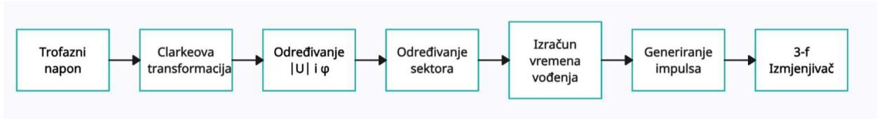
Slika 5.1 Blok dijagram algoritma modulacije prostornog vektora
