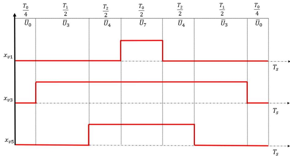
**Slika 4.8** Simetrični obrazac sklapanja ventila za treći sektor
