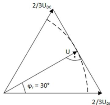
**Slika 4.4.** Određivanje maksimalne amplitudе vektora napona [6]
