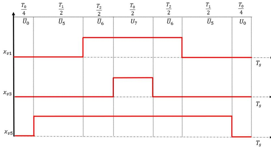
**Slika 4.10** Simetrični obrazac sklapanja ventila za peti sektor
