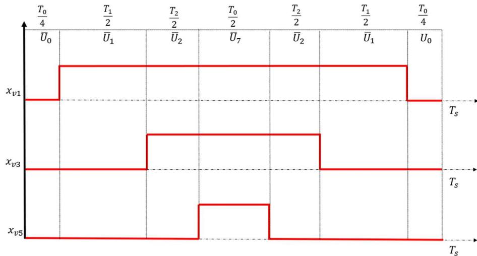
**Slika 4.6** Simetrični obrazac sklapanja ventila za prvi sektor
