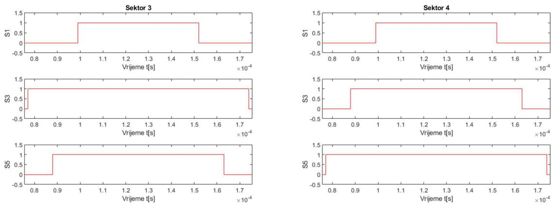
**Slika 5.25** Generirani upravljački signali za treći i četvrti sektor,  $f_s = 10 \text{ kHz}$
