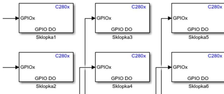
**Slika 6.2** GPIO DO blokovi za definiranje OUT pinova
