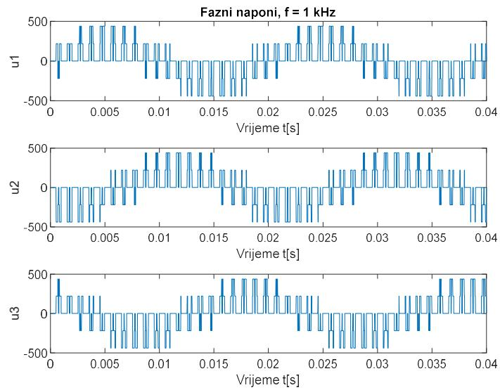
**Slika 5.15** Fazni naponi pri sklopnoj frekvenciji 1 kHz
