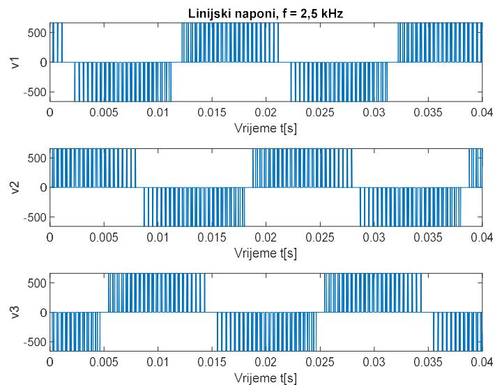
**Slika 5.13** Linijski naponi pri sklopnoj frekvenciji 2,5 kHz
