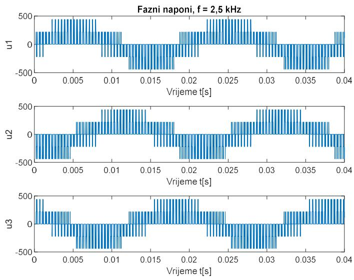
**Slika 5.16** Fazni naponi pri sklopnjoj frekvenciji 2,5 kHz
