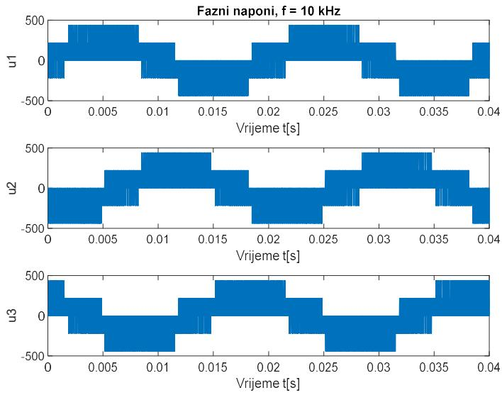
**Slika 5.17** Fazni naponi pri sklopnjoj frekvenciji 10 kHz
