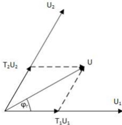
**Slika 4.2** Dobivanje referentnog vektora u prvom sektoru [6]
