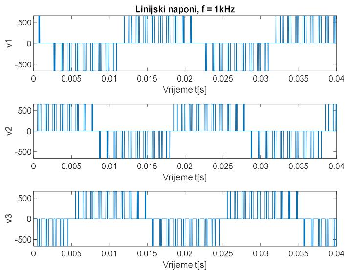
**Slika 5.11** Linijski naponi pri sklopnjoj frekvenciji 1 kHz
