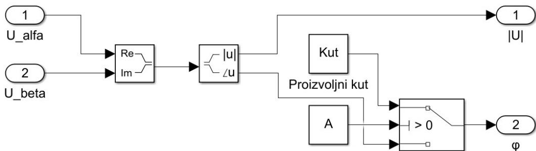
**Slika 5.4** Određivanje modula i kuta prostornog vektora
