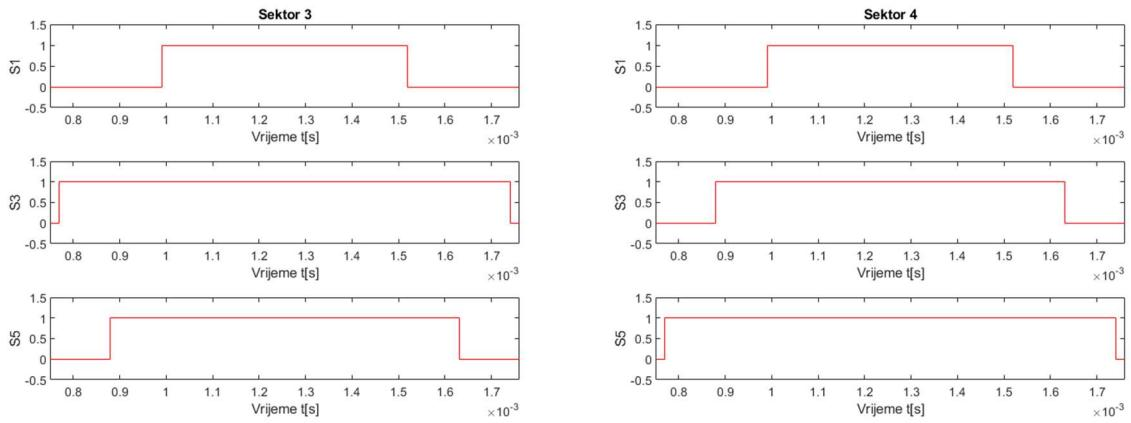
**Slika 5.19** Generirani upravljački signali za treći i četvrti sektor,  $f_s = 1 \text{ kHz}$
