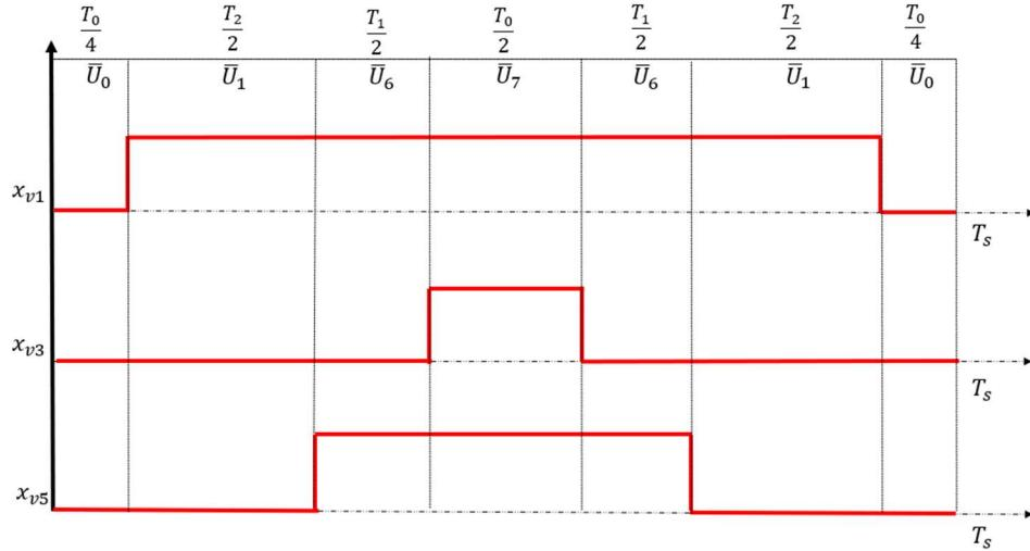
**Slika 4.11** Simetrični obrazac sklapanja ventila za šesti sektor
