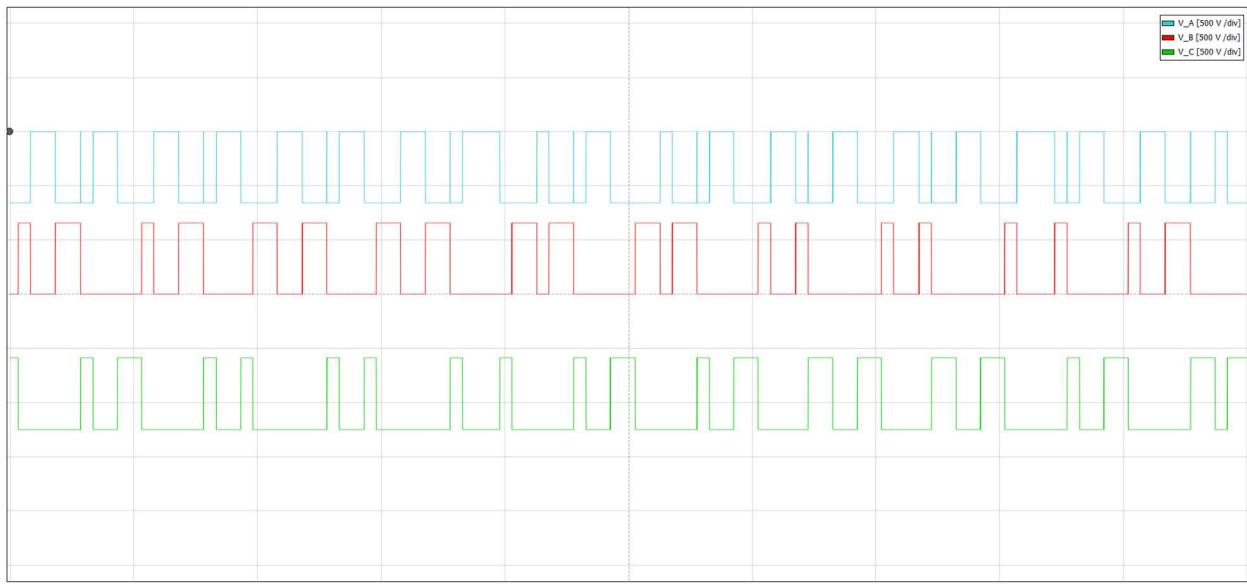
**Slika 6.18** Valni oblik linijskog napona u prvom sektoru,  $f_s = 1 \text{ kHz}$
