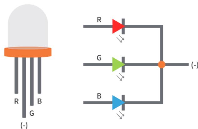
**Slika 2.3** Izgled RGB LED diode sa zajedničkom katodom prema izvoru [4].
