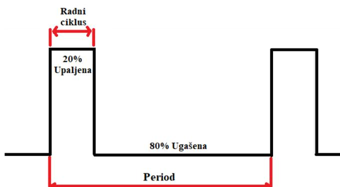
**Slika 2.6** Primjer PWM modulacije prema izvoru [8].
