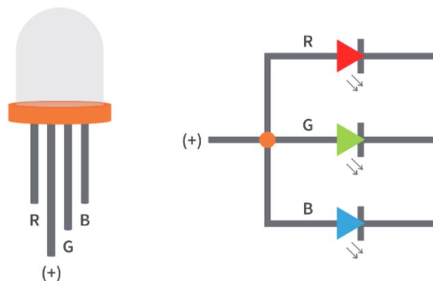
**Slika 2.2** Izgled RGB LED diode sa zajedničkom anodom prema izvoru [4].
