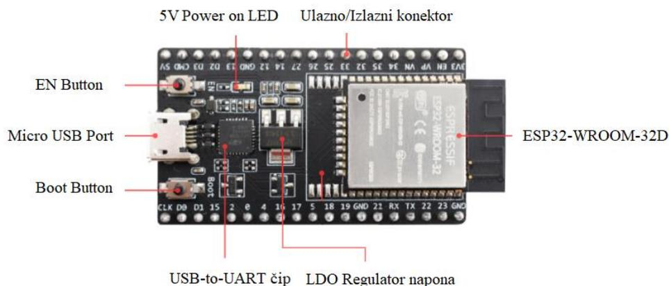
**Slika 3.1.** ESP32-DevKitC V4 sa ESP32-WROOM-32D mikrokontrolerom prema izvoru [11].
