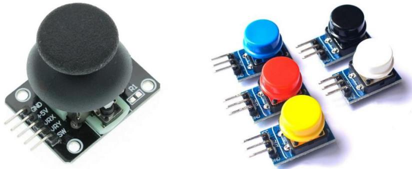
Slika 3.7 Analogna upravljačka palica i gumb modul.
