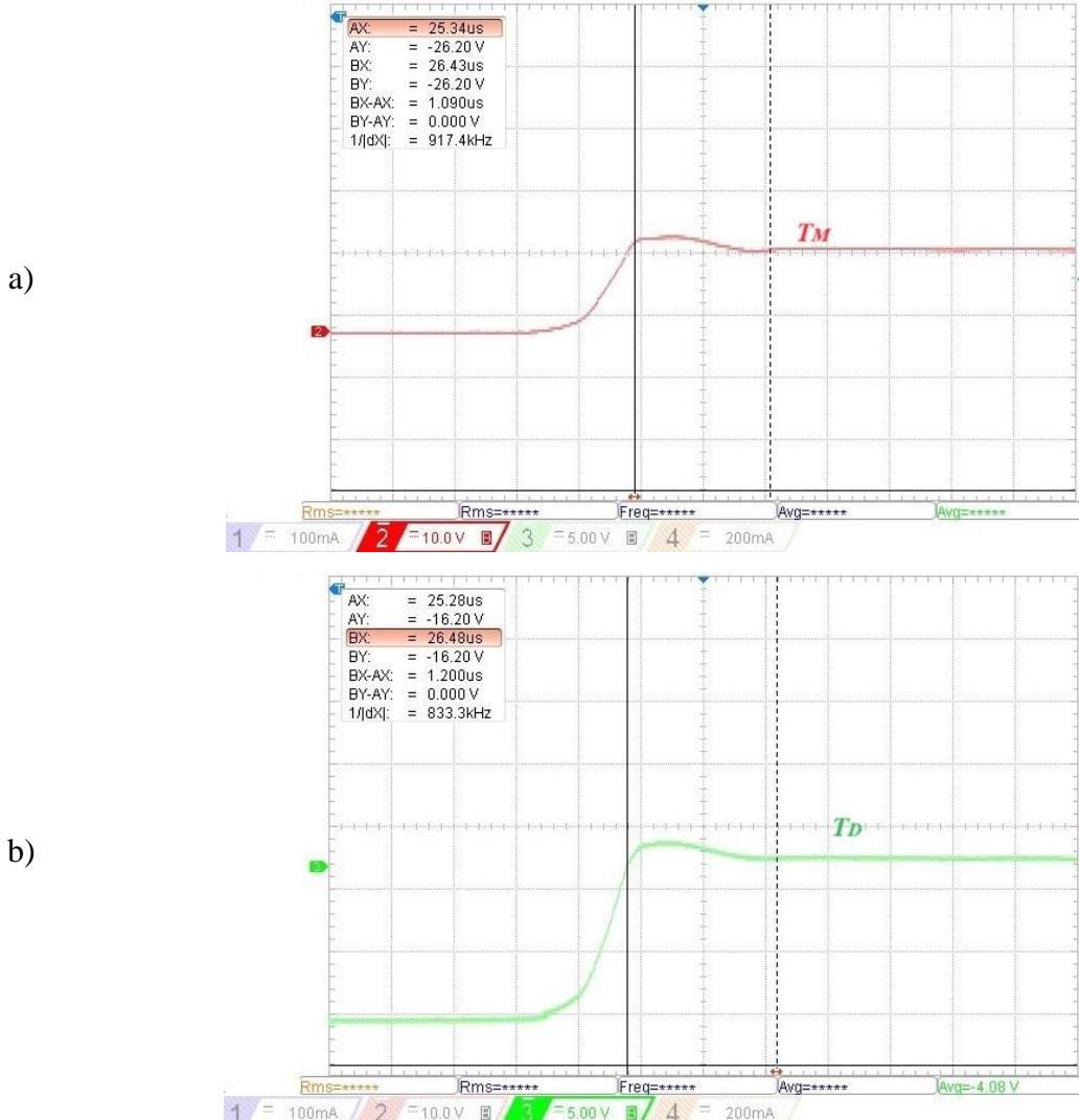
Slika 5.4. Postupak određivanja vremena smirivanja napona: a) MOSFET-a b) diode
