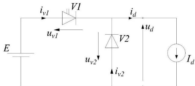
*Slika 3.1. Shema silaznog pretvarača*
