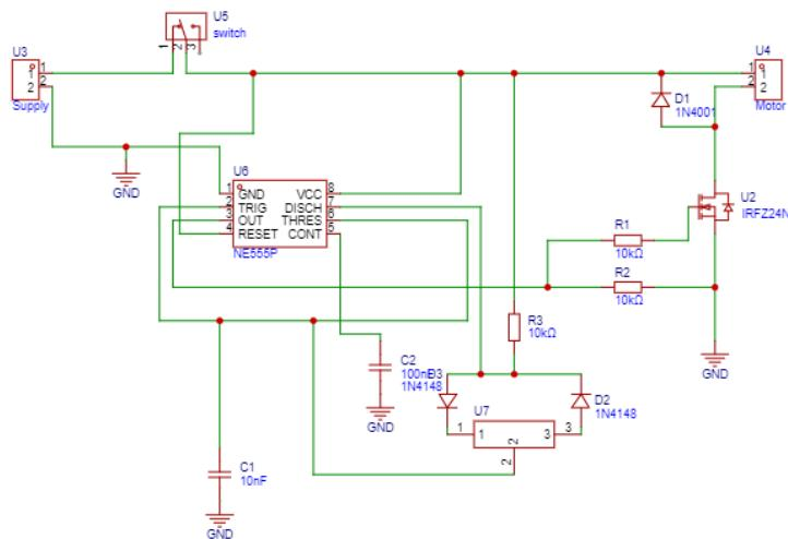
**Slika 4.2. Shema pretvarača kao temelj izrade tiskane pločice**
