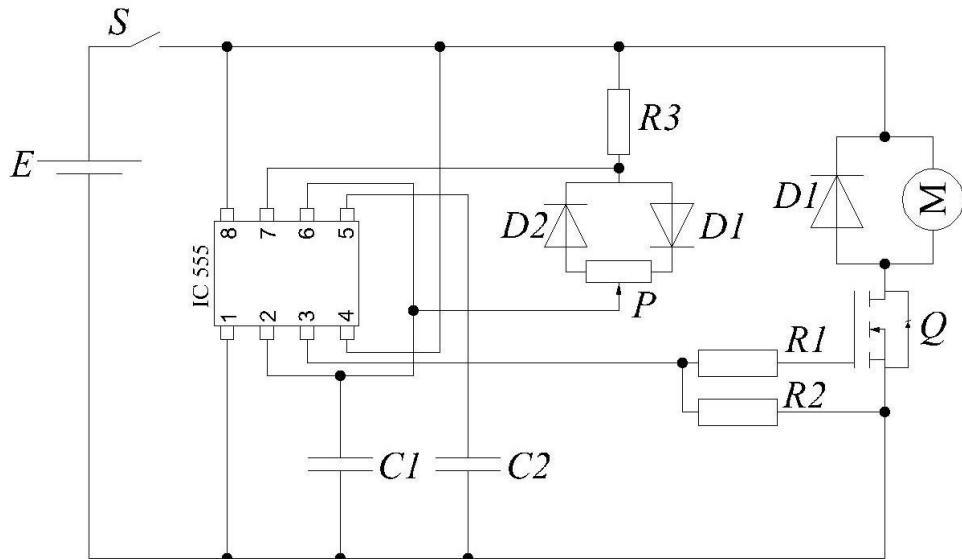
*Slika 4.1. Shema spoja izrađenog silaznog pretvarača*
