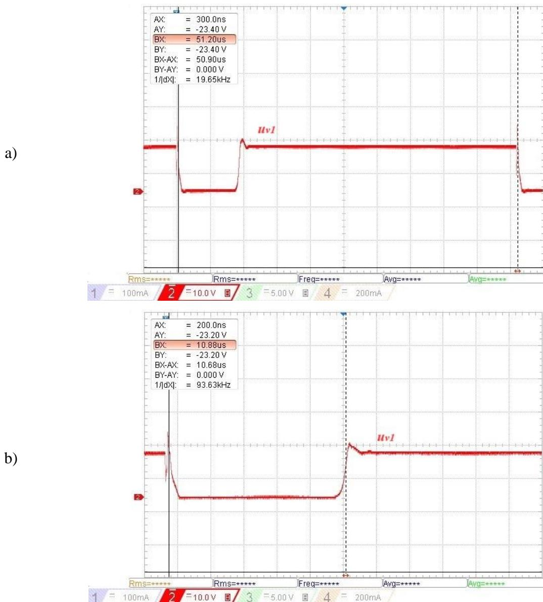
Slika 5.3. Mjerenje: a) sklopne periode, b) vremena vođnja MOSFET-a
