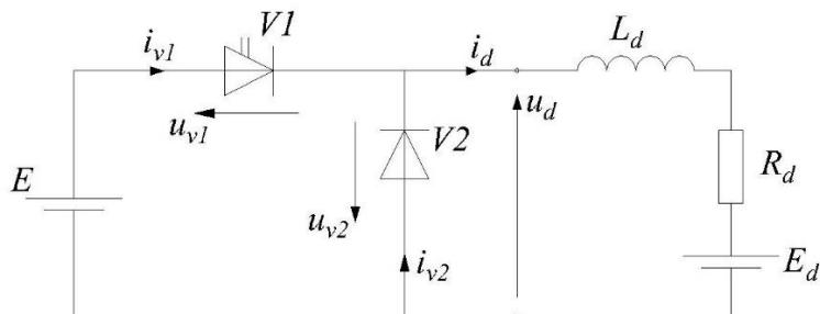
*Slika 3.2. Silazni pretvarač opterećen trošilom valovite struje*
