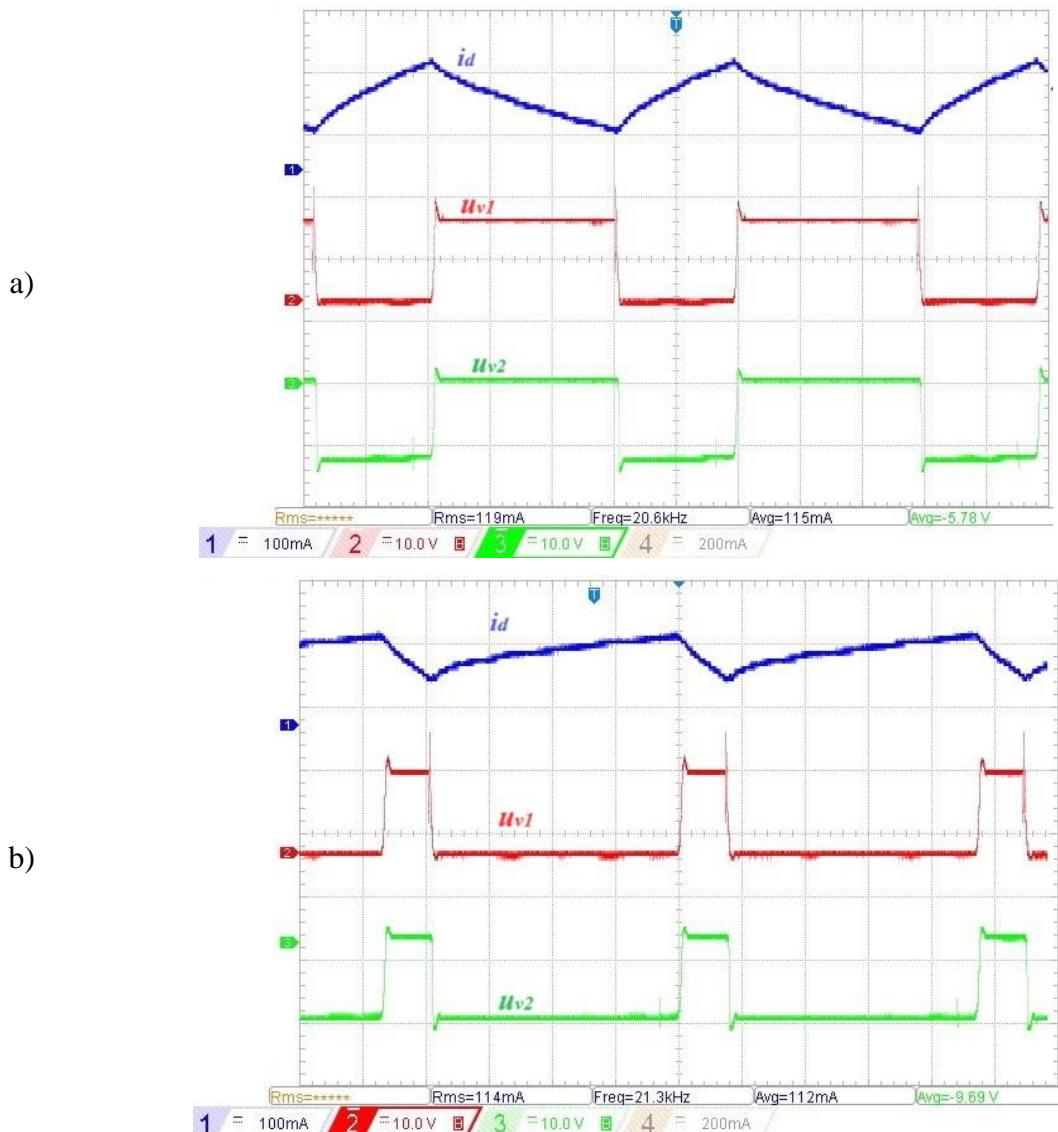
**Slika 5.2. Snimljeni valni oblici pri: a) maloj brzini motora, b) velikoj brzini motora**
