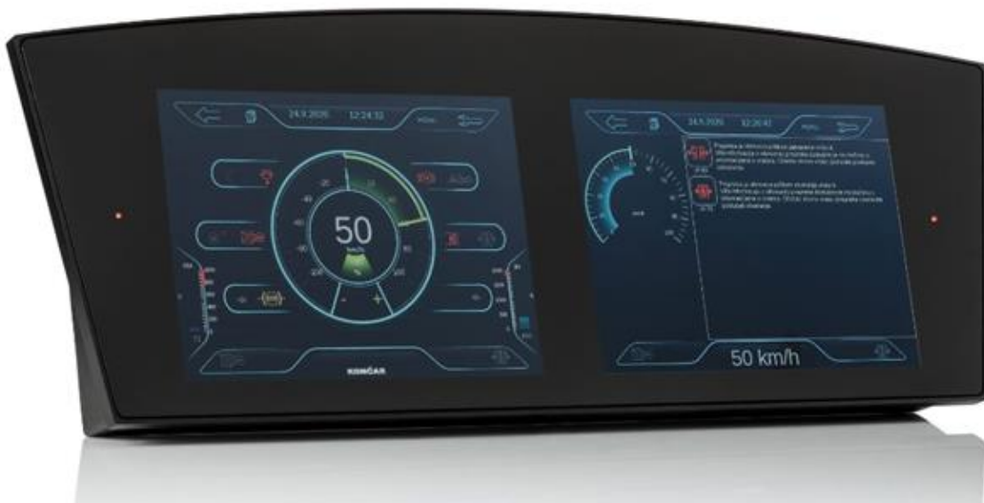
Sl. 2.7. Primjer nove generacije HMI zaslona, za tračnička vozila [11]
