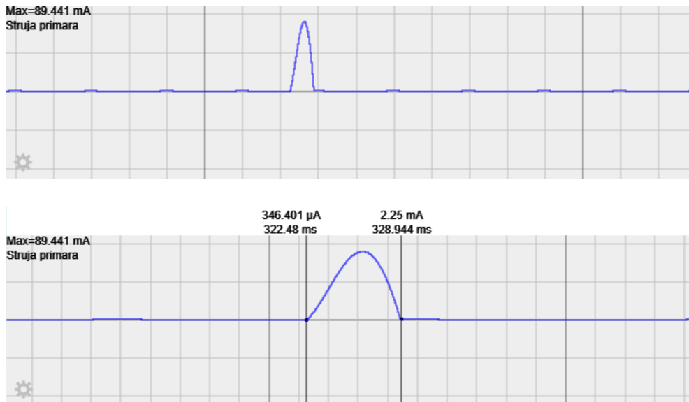
Sl. 5.6 Diskontinuirani valni oblik struje neregularnog režima rada
