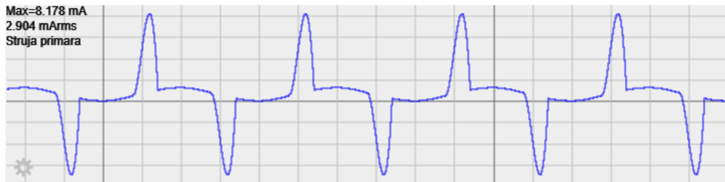
Sl. 5.3 Simulacijski valni oblik struje mrežnog namota
