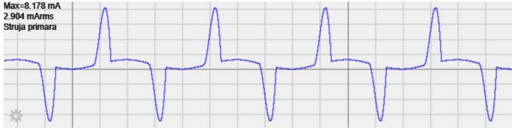
Sl. 5.3 Simulacijski valni oblik struje mrežnog namota
