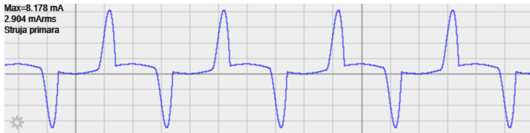
Sl. 5.3 Simulacijski valni oblik struje mrežnog namota
