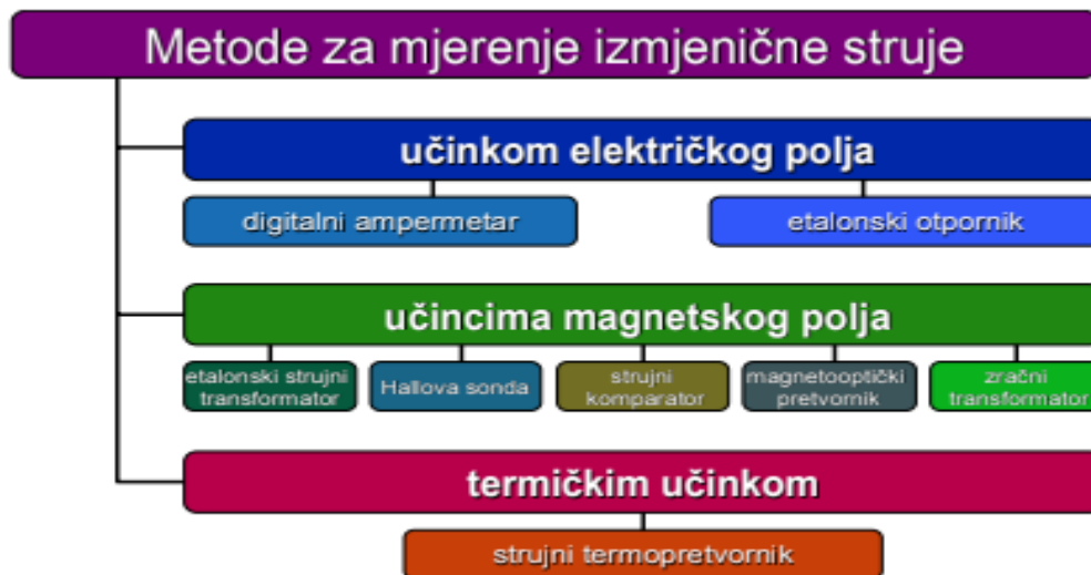
Slika 3.1. Podjela metoda za mjerenje izmjenične struje [1]
