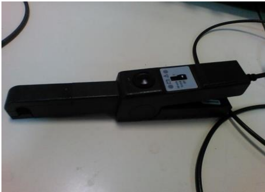
Slika 5.1. Strujna kliješta – Tektronix A622 AC/DC CURRENT PROBE [24]
