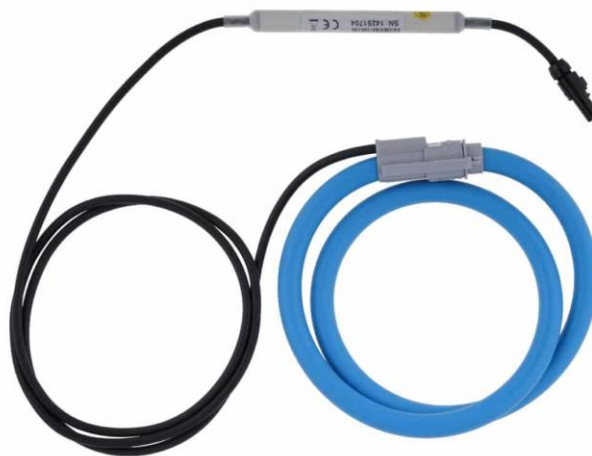
Slika 4.2. Fleksibilna izvedba strujnog pretvornika u obliku Rogowskijevog svitka [17]
