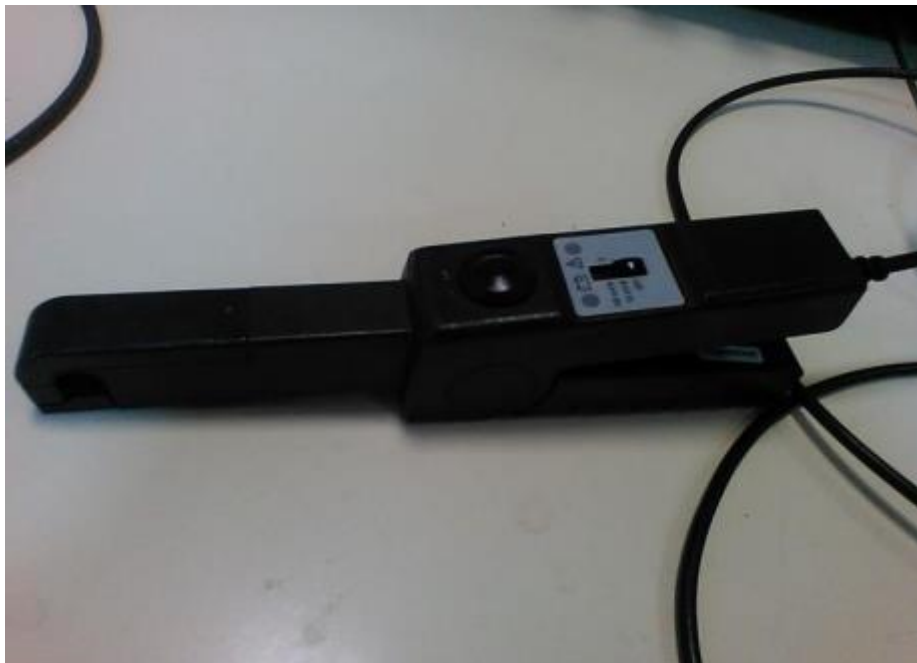
Slika 5.1. Strujna kliješta – Tektronix A622 AC/DC CURRENT PROBE [24]
