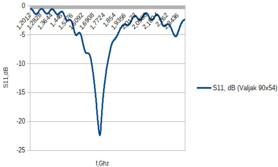
**Slika 4.2.2** Rezultati mjerenja parametra  $S_{11}$  otvor antene sa plaštom oblika valjka dimenzije 90x54mm
