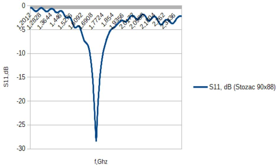
**Slika 4.1.5** Rezultati mjerenja parametra  $S_{11}$  otvor antene sa plaštom oblika stošca dimenzije 90x88mm
