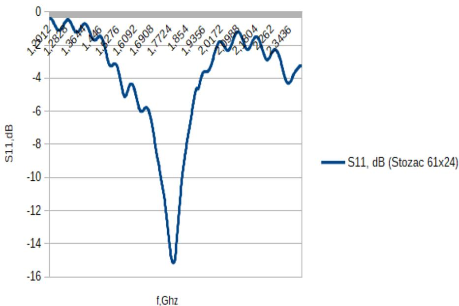
**Slika 4.1.1** Rezultati mjerenja parametra  $S_{11}$  otvor antene sa plaštom oblika stošca dimenzija 61x24 mm
