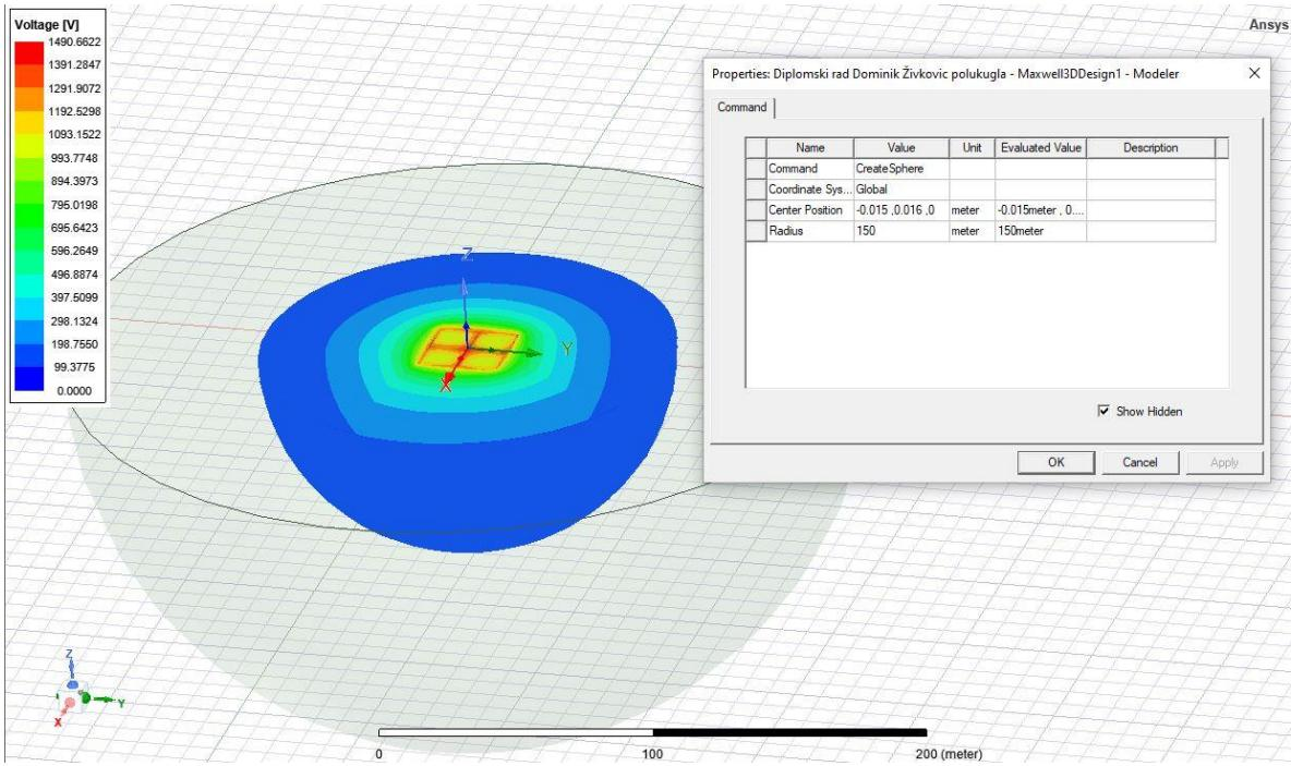
**Slika 4.23.** Model zemlje u polukuglastom okruženju radijusa 150 m.
