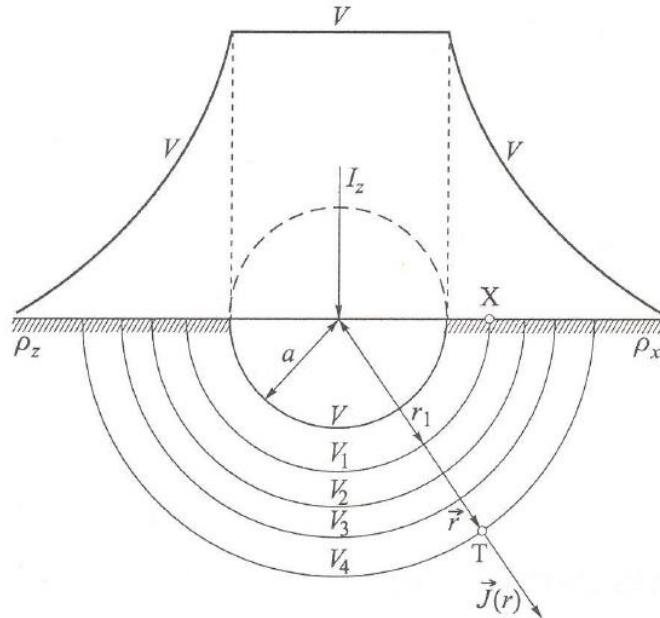
**Slika 2.13.** Razdioba potencijala  $V$  polukuglastog uzemljivača [3].
