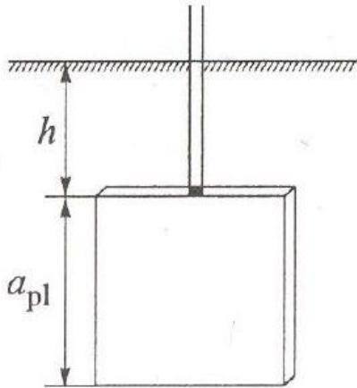
**Slika 2.10.** Pločasti uzemljivač ukopan u dubinu  $h$  [1].
