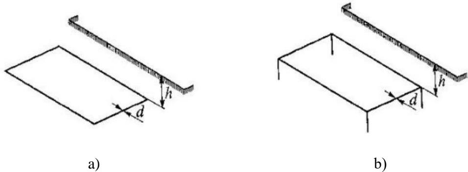
**Slika 2.12.** a) Prstenasti uzemljivač četverokutnog oblika, b) Prstenasti uzemljivač četverokutnog oblika sa štapnim uzemljivačima [1].
