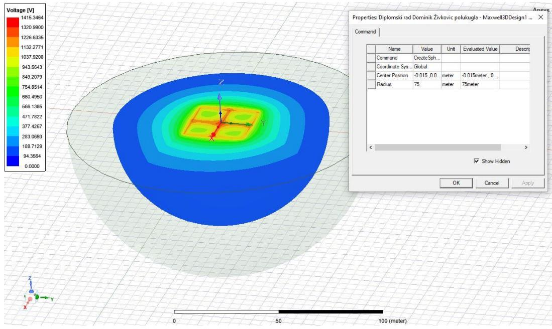
**Slika 4.21.** Model zemlje u polukuglastom okruženju radijusa 75 m.
