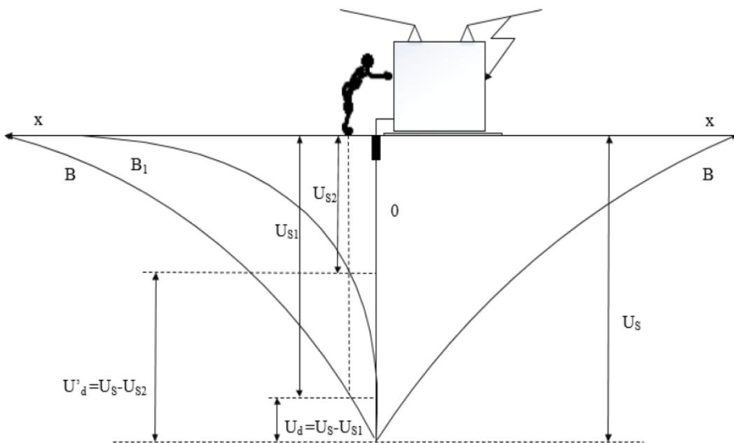
Slika 2. 2. Napon dodira i raspodjela potencijala oko uzemljivača [1].
