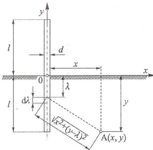
**Slika 2.9.** Položaj štapnog uzemljivača za određivanje potencijala na površini zemlje i otpora uzemljenja [5].
