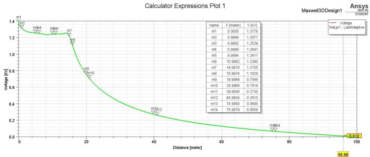
**Slika 4.18.** Potencijalni lijevak mrežastog uzemljivača ukopanog na dubini od 1 m. Okomiti smjer.
