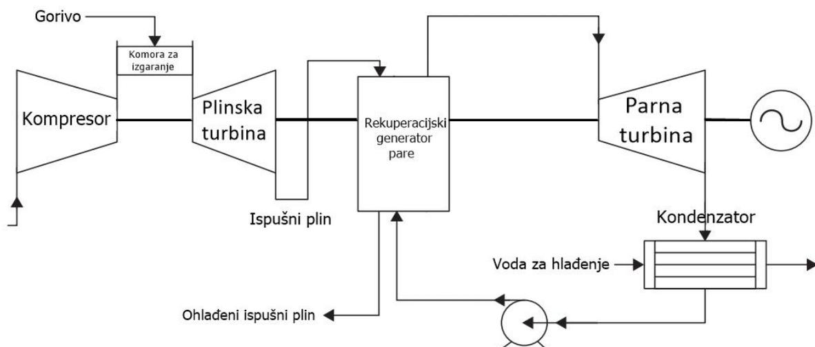
*Slika 2.3. – Pojednostavljena blok shema kombinirane plinsko-parne termoelektrane [2]*
