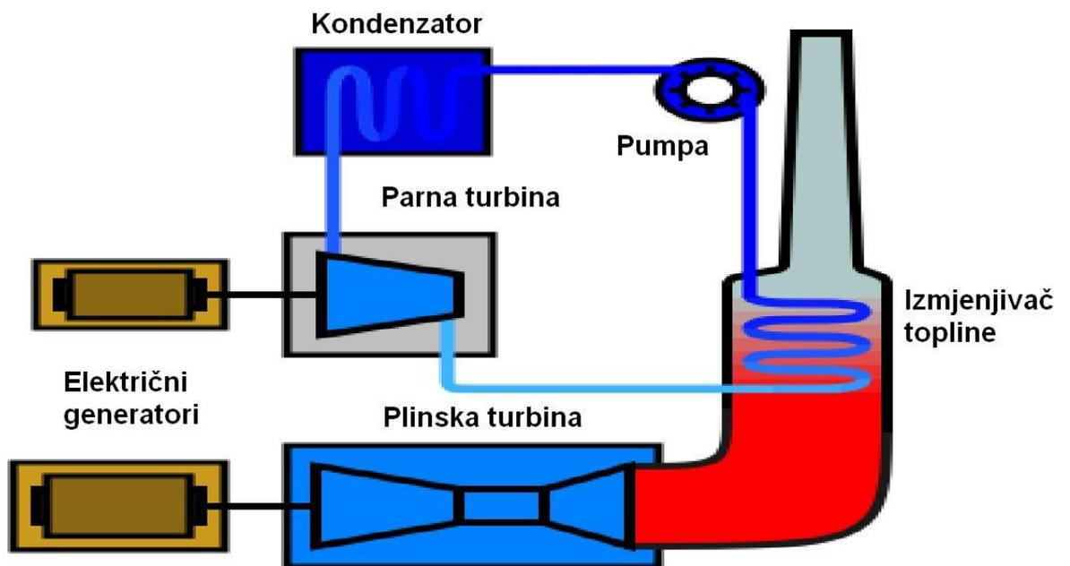
*Slika 2.1. Pojednostavljeni princip rada elektrane s kombiniranim ciklusom [16]*
