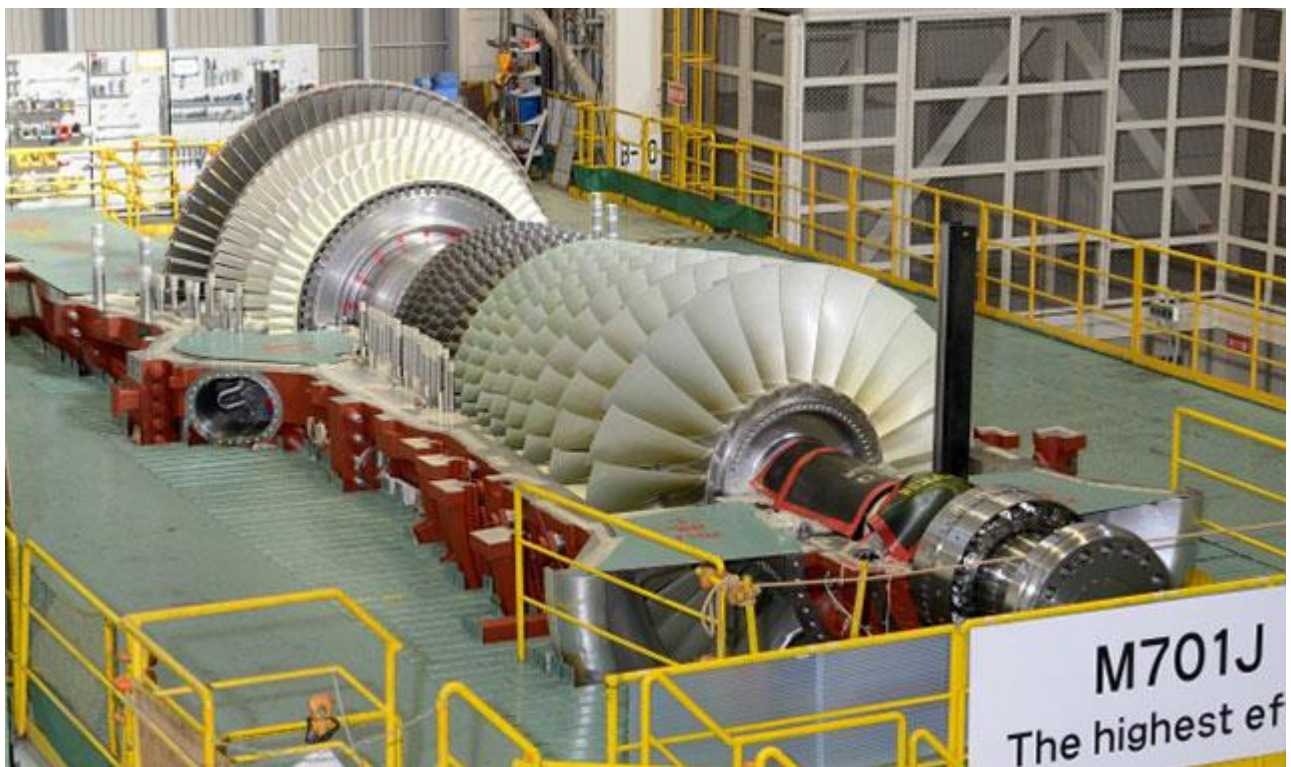
Slika 3.4. – Mitsubishi M701J turbina [12]
