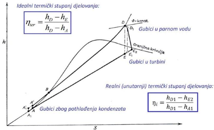
Slika 4.6. – Prikaz idealnog irealnog jednostavnog Rankineovog ciklusa
