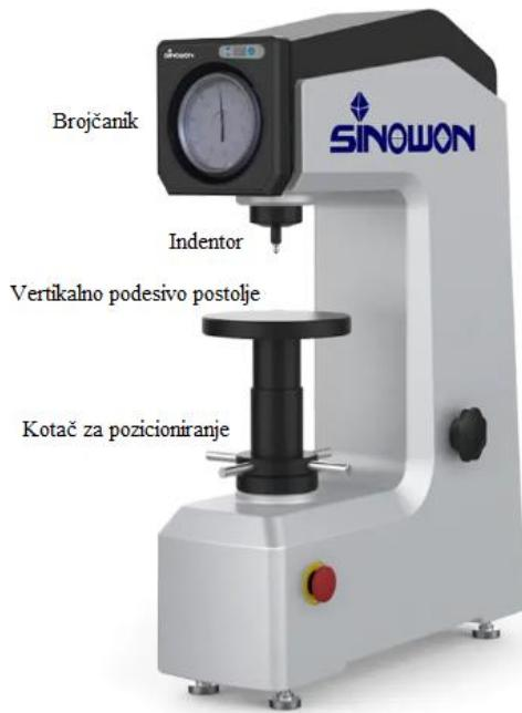
S1.3.8.Rockwellov uređaj za ispitivanje tvrdoće
