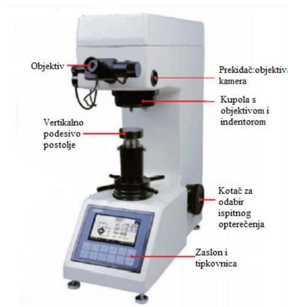
S1.3.6. Vickersov uređaj za ispitivanje tvrdoće [7]
