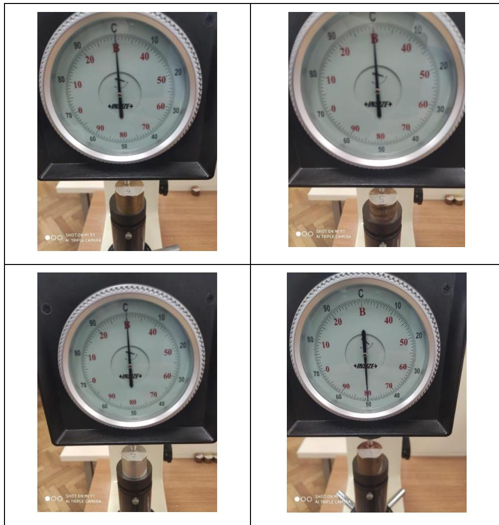
Ispitivanje tvrdoće stacionarnim uređajem Brinellovom metodom provedeno je pri opterećenju od 1471 N za čelike te 588,4 N za obojene metale.
