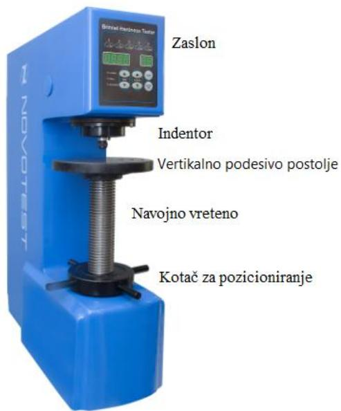
Sl. 3.2.Brinellov uređaj za ispitivanje tvrdoće
