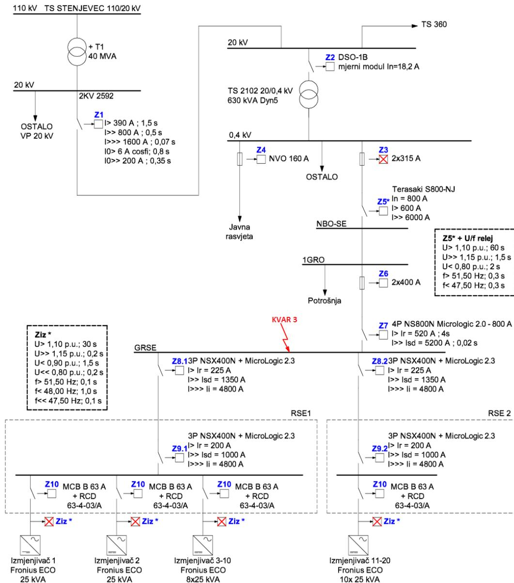
Slika 5.10. Shematski prikaz simulacije za slučaj kvara 3
