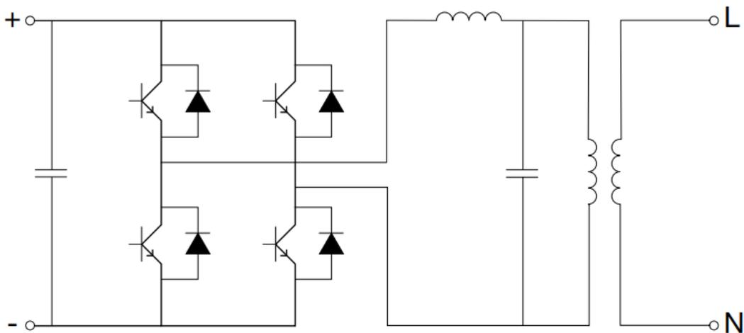
Slika 2.4. Shema jednofaznog izmjenjivača [10]
