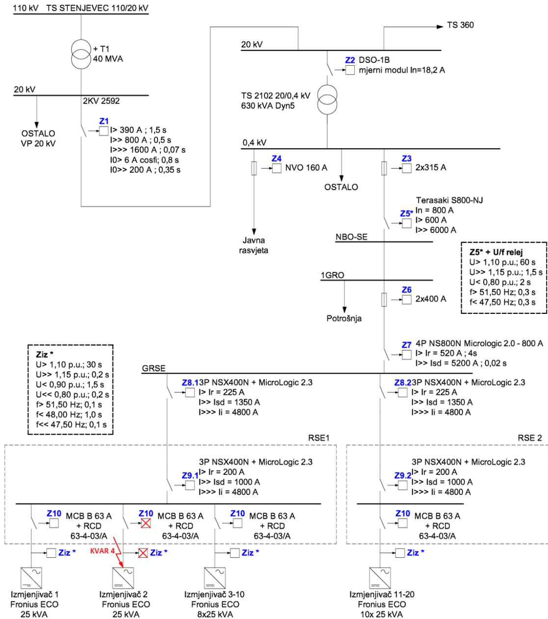
Slika 5.12. Shematski prikaz simulacije za slučaj kvara 4
