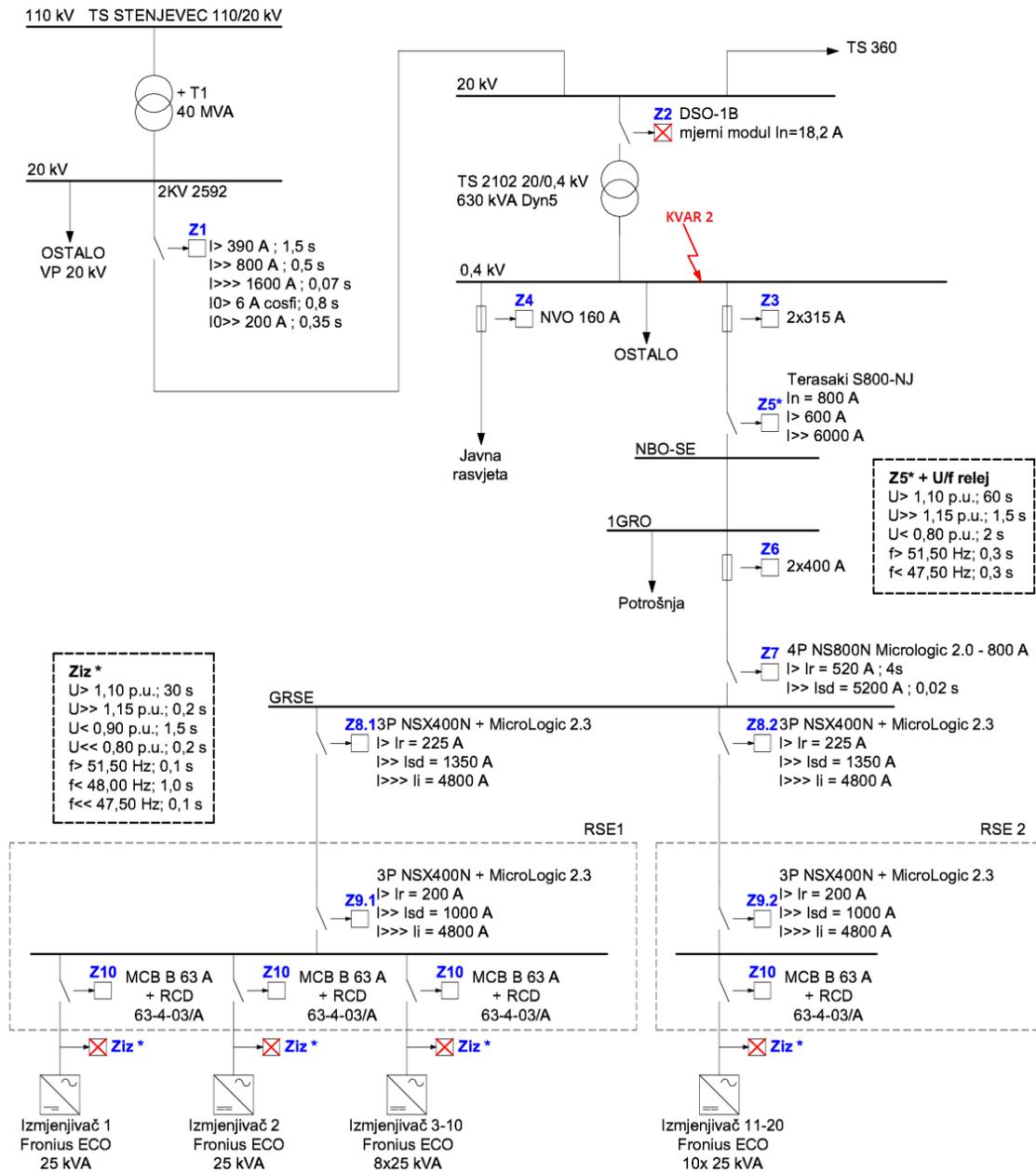
Slika 5.8. Shematski prikaz simulacije za slučaj kvara 2
