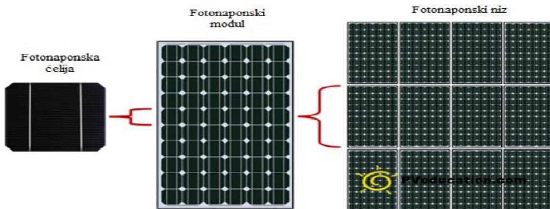
Slika 2.2. Primjer slaganja fotonaponskih ćelija [6]
