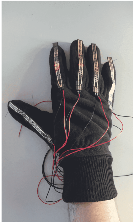
Sl. 3.1 Upravljačka rukavica sa senzorima
