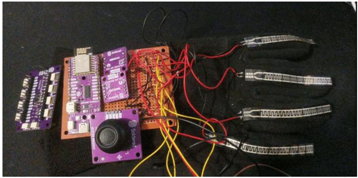
Sl. 3.2 Senzori zalemjeni na bušenu pločicu prema shemi
