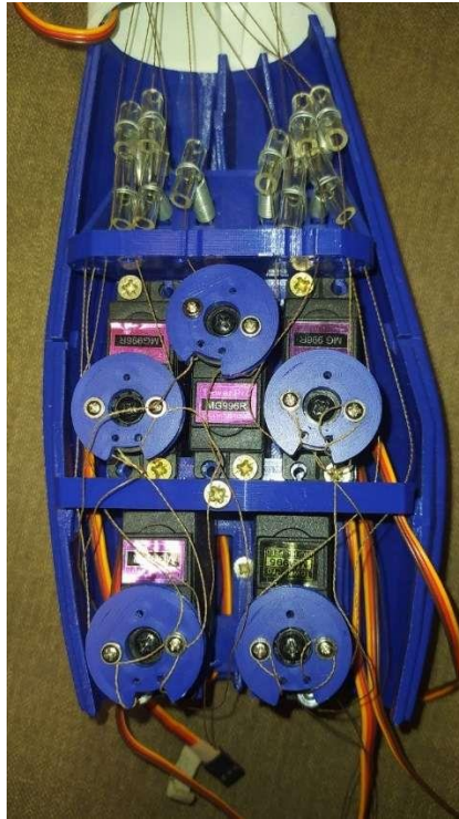
Sl. 4.1 Slika postavljenih remenica na motorima
