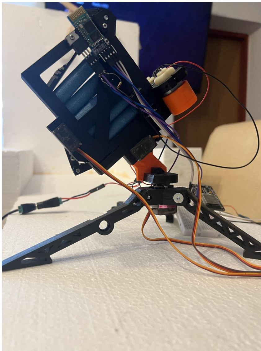
Slika 3.11. Prikaz pomicanja strukture prema gore pomoću servo motora.
