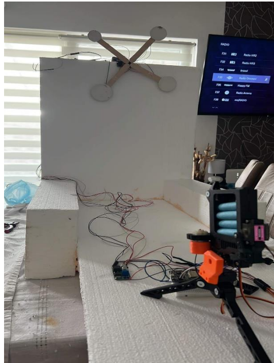
Slika 4.1. Maketa sustava za gađanje i pokretne mete.
