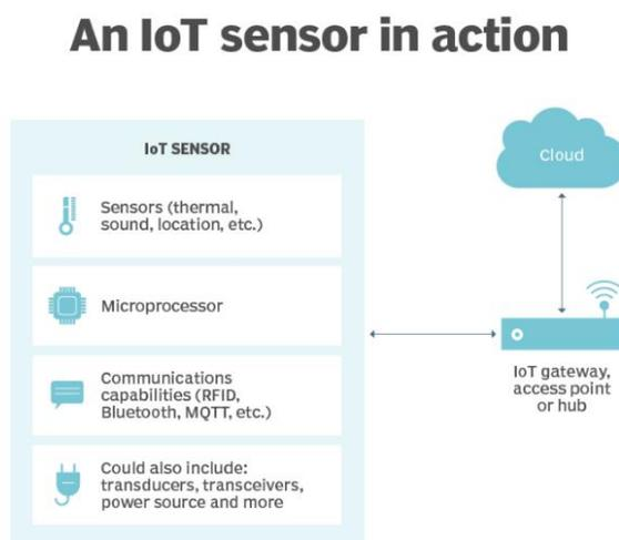
Slika 1. Dijagram koji prikazuje IoT senzor u akciji [3]
