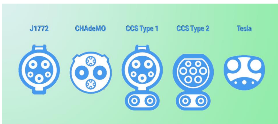
Slika 3.1.2.1. Pregled konektora za punjenje električnih vozila.[9]
