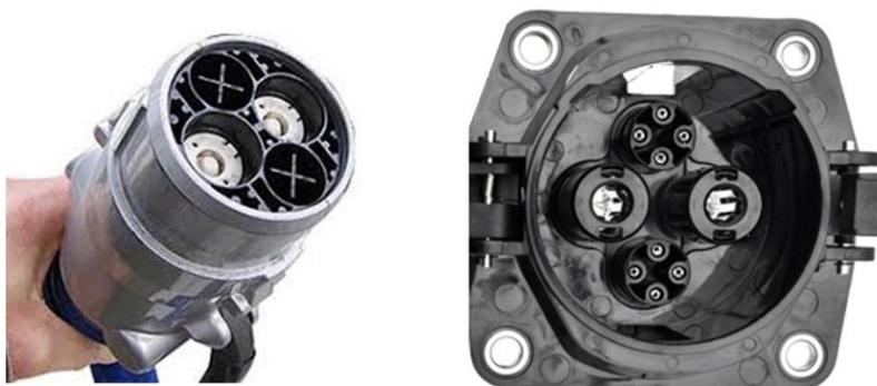
**Slika 3.1.2.3.** CHAdeMO konektor: utikač lijevo i utičnica desno. [10]
