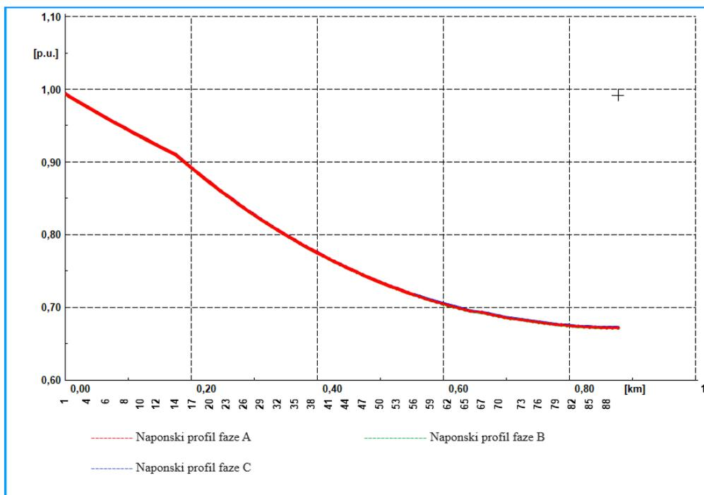
**Slika 5.2.4.** Naponski profil za 50% punjača 11 kW.
