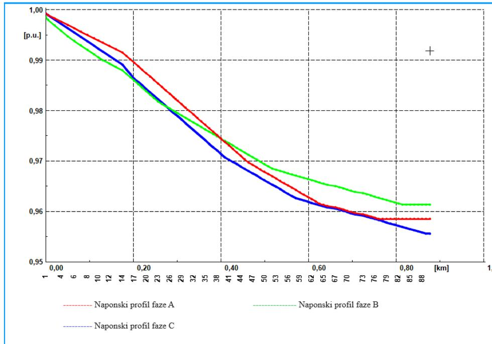
**Slika 5.2.13.** Naponski profil za 12 punjača snage 3.7 kW.
