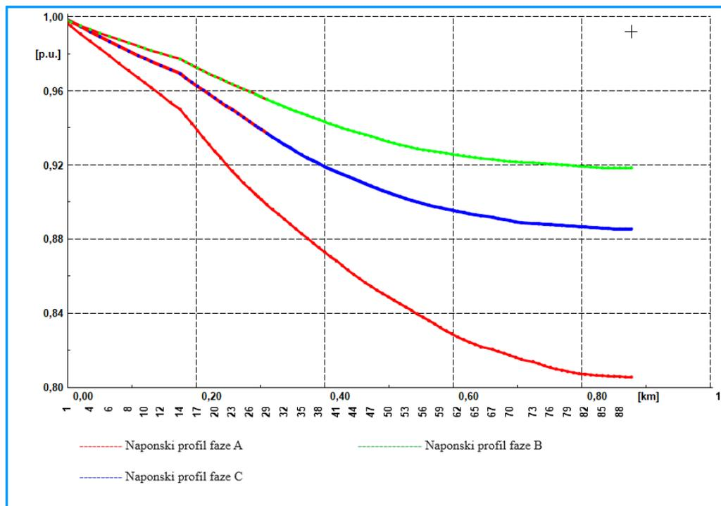
**Slika 5.2.7.** Naponski profil za 50% punjača snage 3.7 kW.
