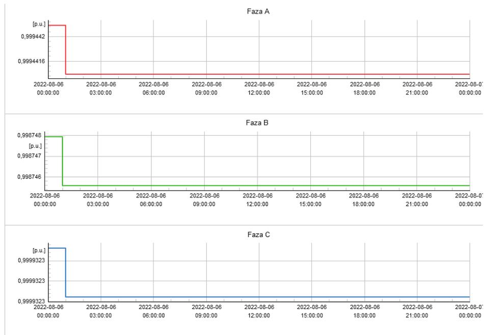
**Slika 5.2.3.** Naponski profil po fazama na zadnjem izvodu br.90.
