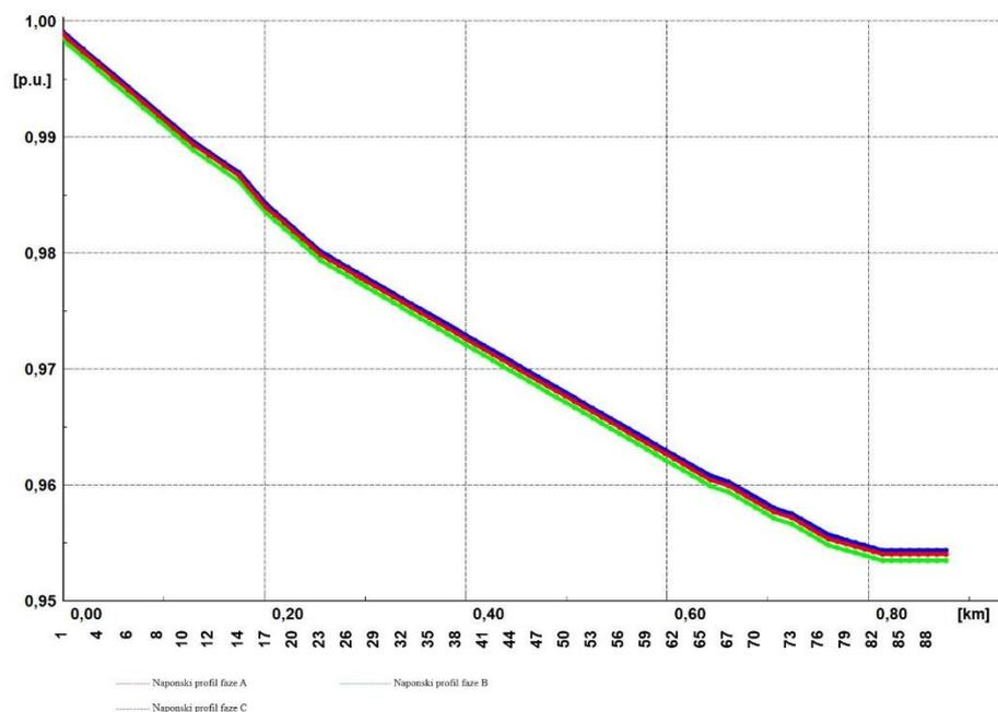
**Slika 5.2.10.** Naponski profil za pet punjača snage 11 kW.
