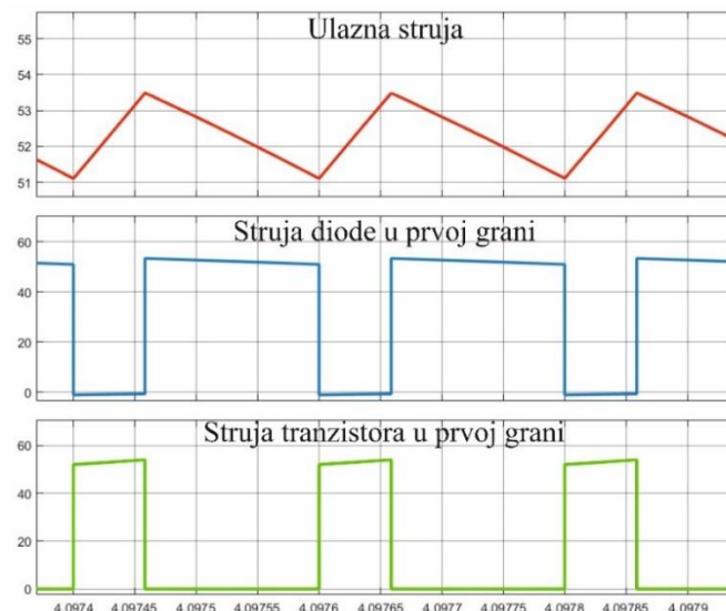
Slika 5.5. Karakteristični valni oblici struja pretvarača s uključenom jednom granom
