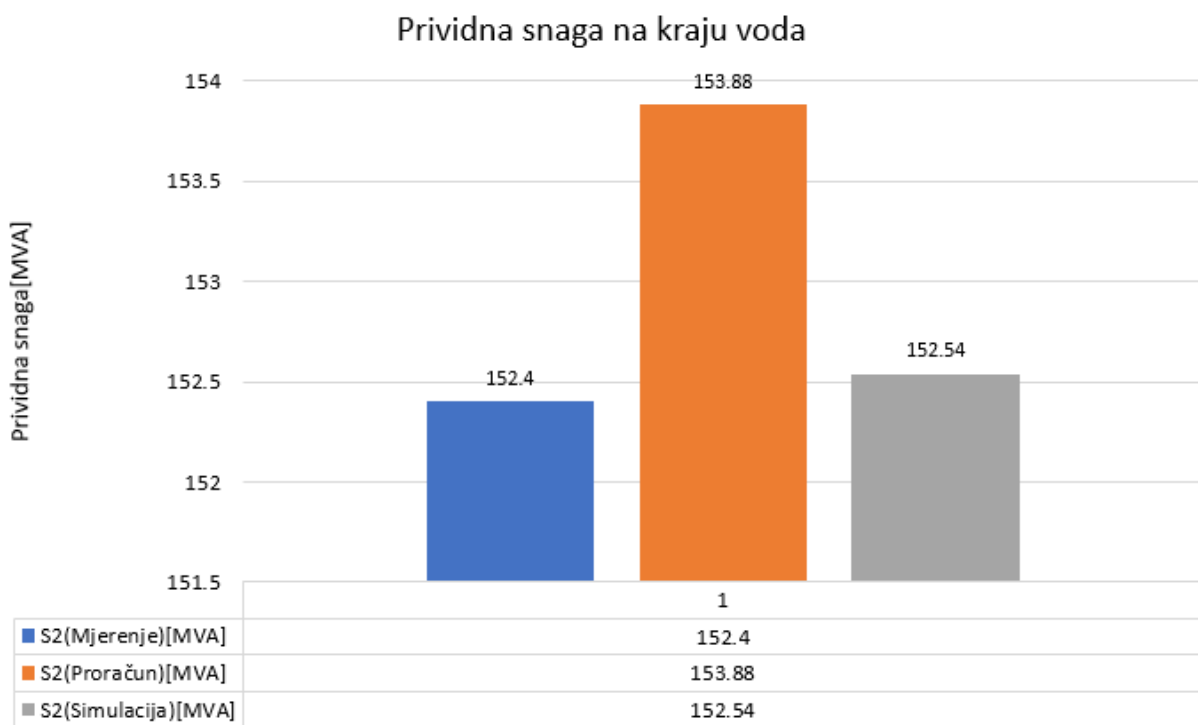
Slika 7.14. Rezultati prividnih snaga na kraju opterećenog voda duljine 360 km.
