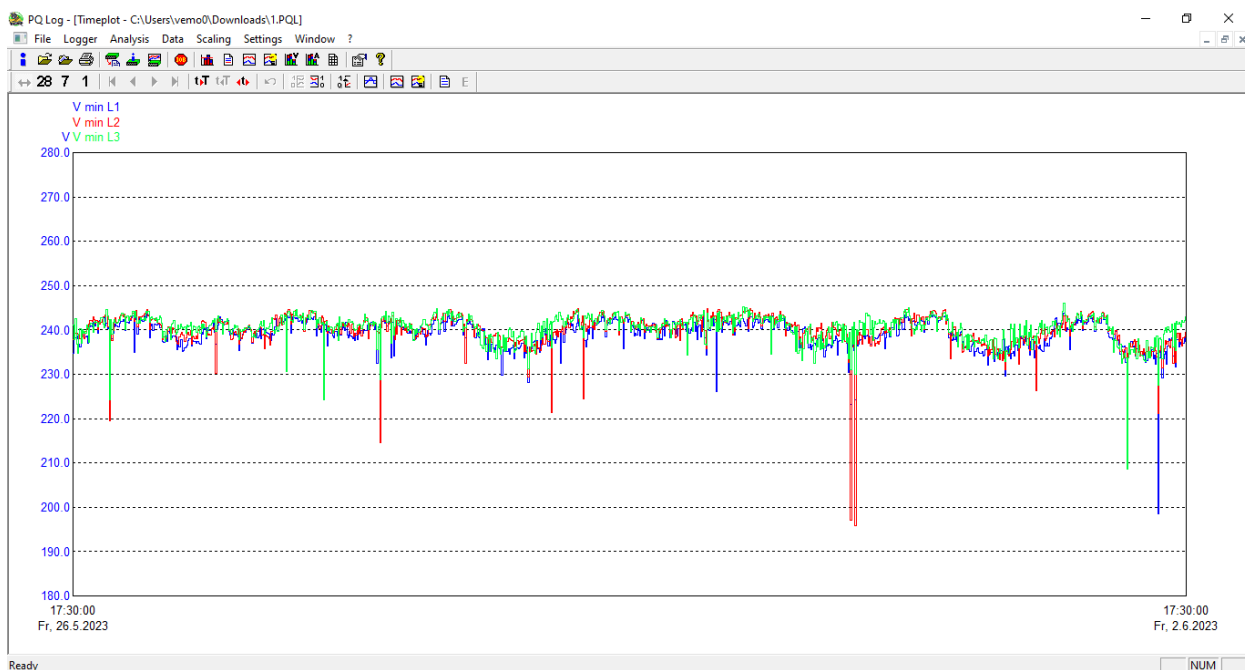
Slika 4.5. Prikazuje minimalne vrijednosti napona napajanja
