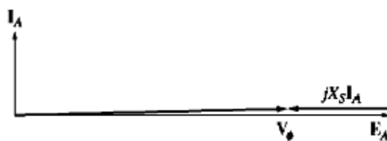
Slika 2.11: Fazorski dijagram sinkronog kondenzatora [1]
