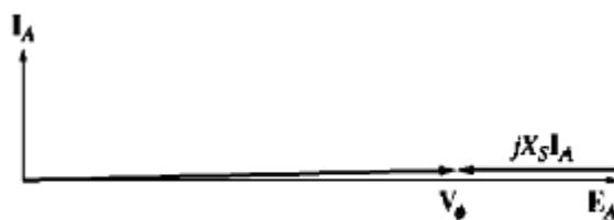
Slika 2.11: Fazorski dijagram sinkronog kondenzatora [1]
