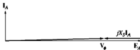
Slika 2.11: Fazorski dijagram sinkronog kondenzatora [1]
