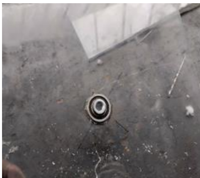
Slika 5.4 Lijepljenje ležajeva 6203 na postolje
