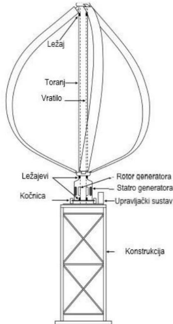
Slika 4.7 Darrieus klasični model vjetroturbine [17]
