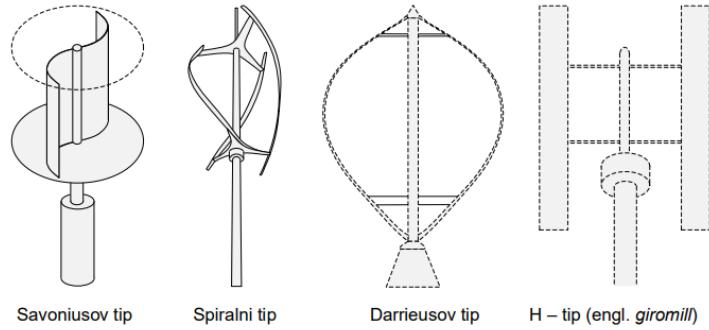
Slika 4.8 Tipovi vjetroturbine s vertikalnom osi vrtnje [8]
