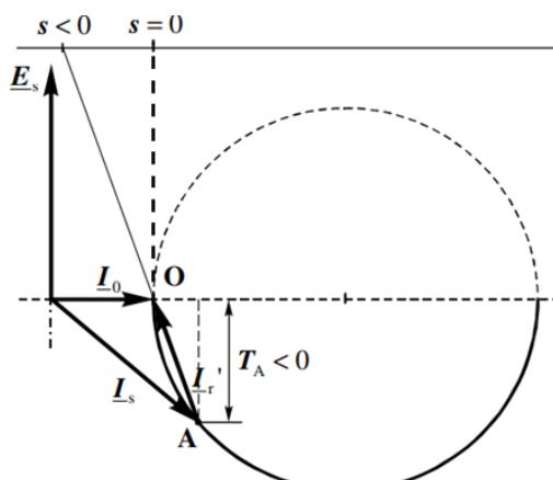
Slika 4.13 Radna točka asinkronog generatora [21]
