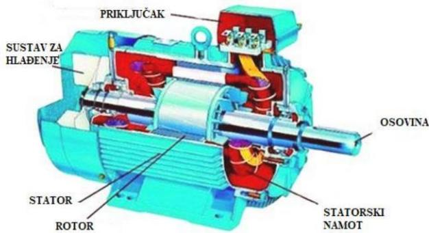
Slika 4.12 Presjek asinkronog generatora [20]
