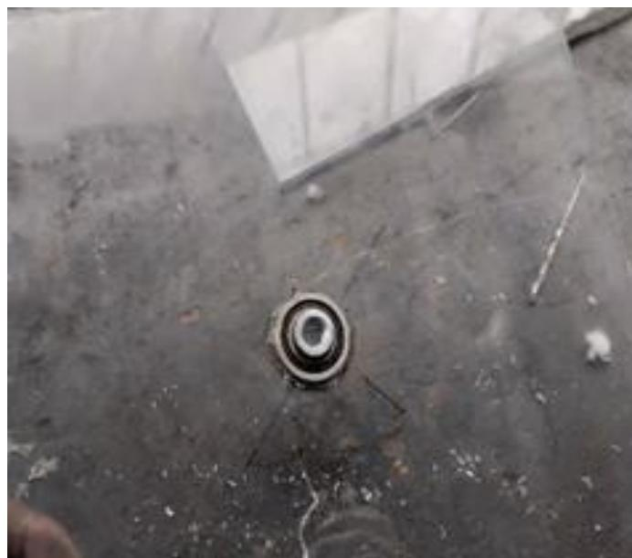
Slika 5.4 Lijepljenje ležajeva 6203 na postolje
