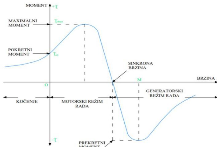
Slika 4.14 Ovisnost momenta o brzini vrtnje u cijelom području rada [19]
