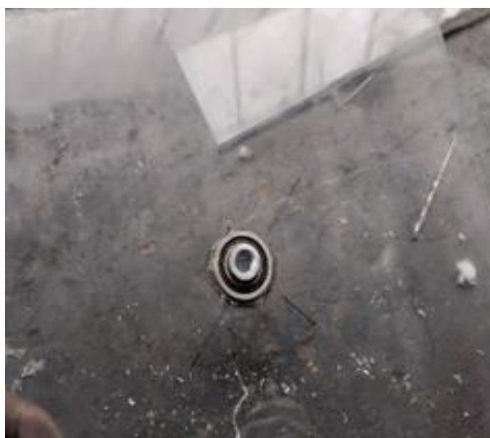
Slika 5.4 Lijepljenje ležajeva 6203 na postolje
