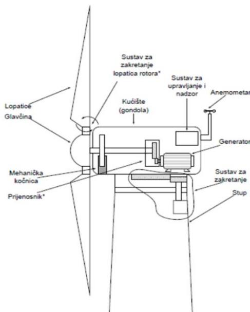
Slika 4.2 Dijelovi vjetroagregata s horizontalnom osovinom [8]
