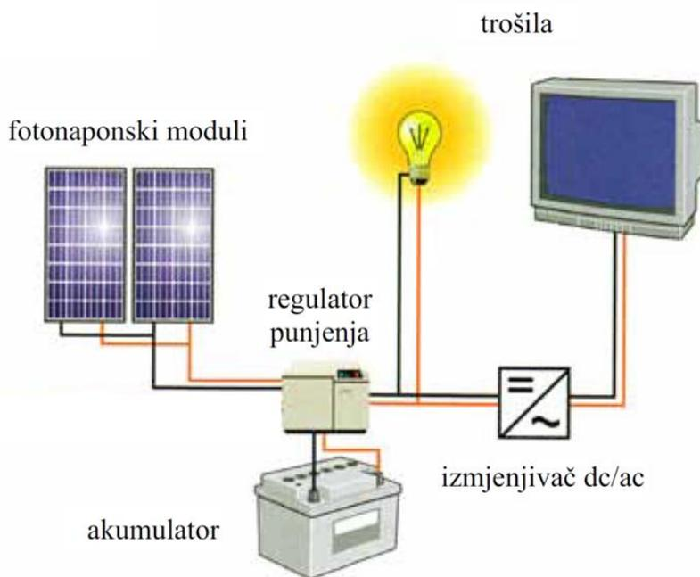
**Slika 2.1.** Fotonaponski sustavi
