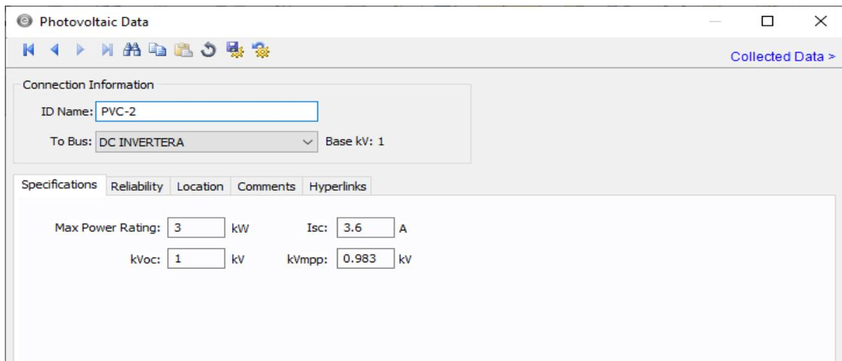
**Slika 5.6.** Podaci fotonaponskog modula 2 iz programskog alata EasyPower
