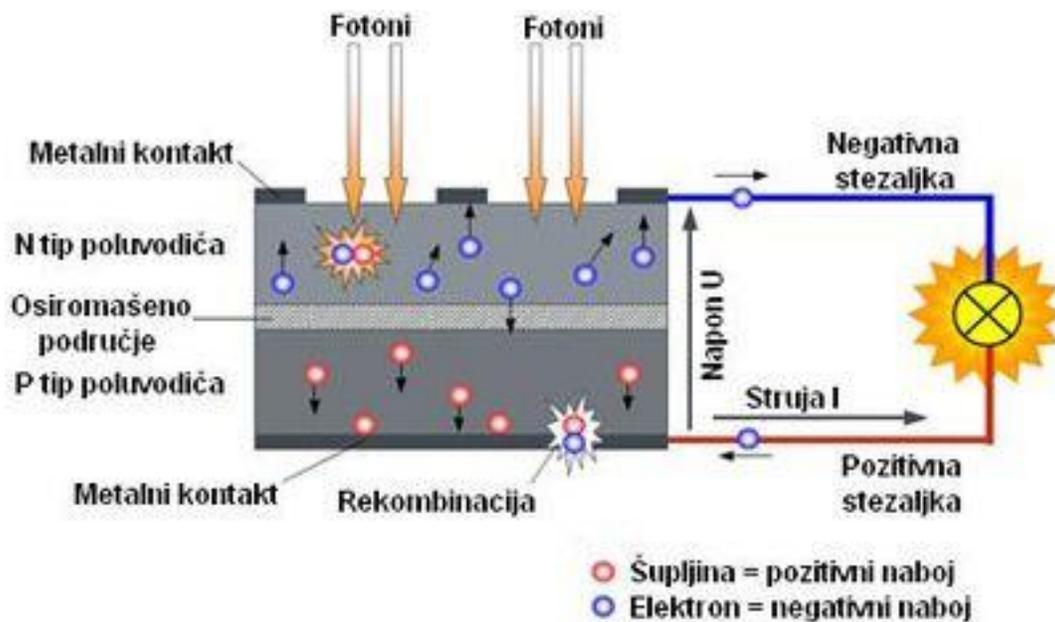
Slika 2.6. Prikaz nastanka para elektron-šupljina u solarnoj ćeliji [5]
