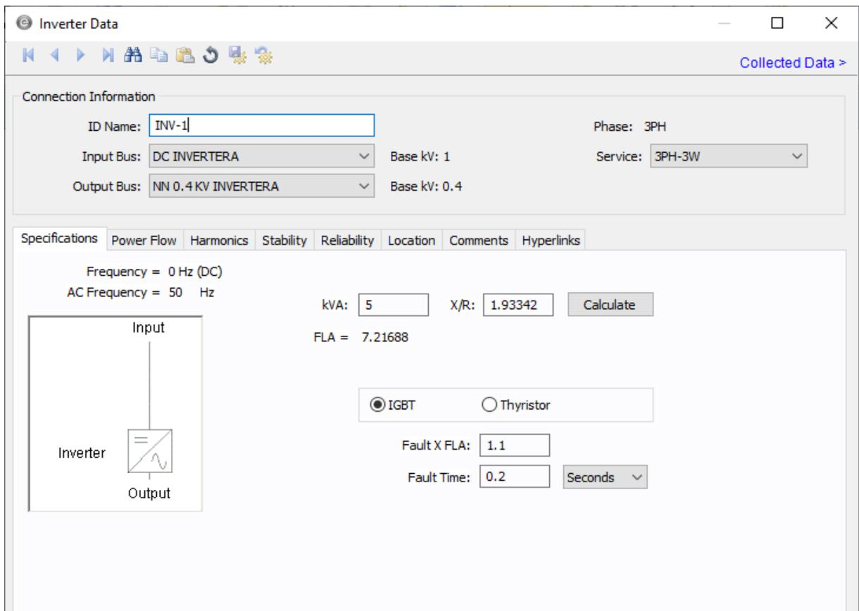
**Slika 5.3.** Podaci izmjenjivača iz programskog alata EasyPower
