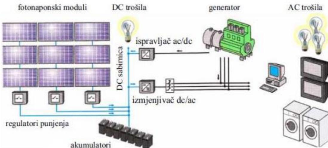
**Slika 3.2.** Shema samostalnog hibridnog FN sustava s generatorom [5]
