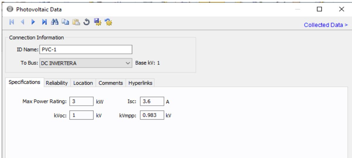
**Slika 5.5.** Podaci fotonaponskog modula 1 iz programskog alata EasyPower
