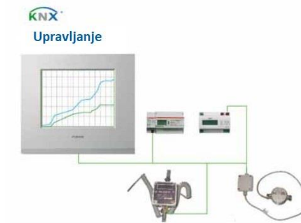
Slika 2.7. : Shematski prikaz povezivanja s KNX Metering pristupnikom [24]
