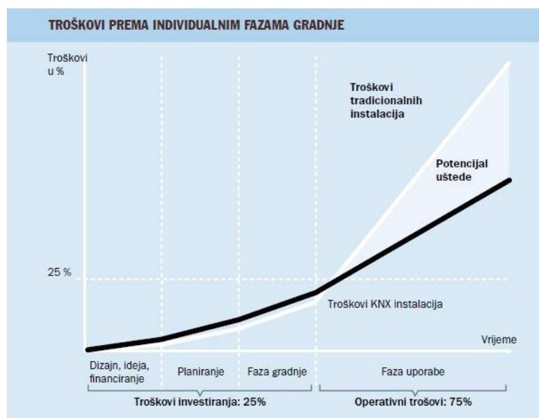
**Slika. 2.5. :** Troškovi instalacija prema fazama ugradnje [20]
