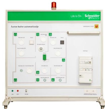
**Slika 3.3. : Schneider Electric sustav kućne automatizacije - AET-P01-HAS [35]**
