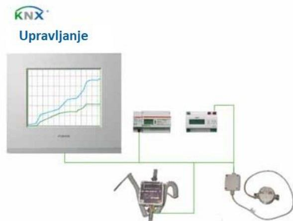
**Slika 2.7. : Shematski prikaz povezivanja s KNX Metering pristupnikom [24]**
