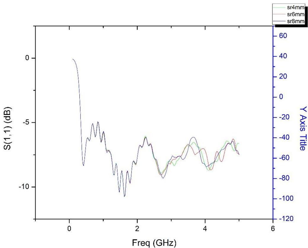
Slika 4.12. Simulacijski rezultati koeficijenta refleksije  $S_{11}$  za slučaj rezonatora za koji vrijedi:  $R_2 = 0.64R_1$  ( $R_1$  – radius vanjskog prstena);  $R_2$  – radius unutarnjeg prstena; sr – debljina prstena).
