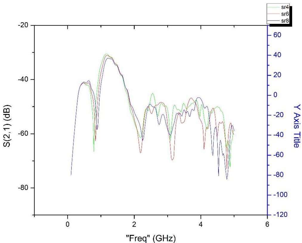
Slika 4.3. Simulacijski rezultati koeficijenta transmisije  $S_{21}$  za slučaj rezonatora za koji vrijedi:  $R_2 = 0.64R_1$  ( $R_1$  – radijus vanjskog prstena);  $R_2$  – radijus unutarnjeg prstena;  $sr$  – debљina prstena).
