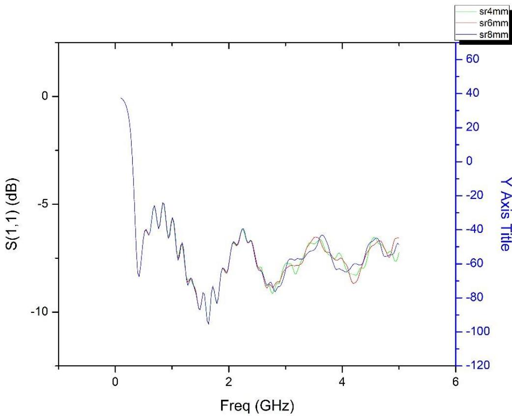
Slika 4.11. Simulacijski rezultati koeficijenta refleksije  $S_{11}$  za slučaj rezonatora za koji vrijedi:  $R_2 = 0.50R_1$  ( $R_1$  – radijus vanjskog prstena);  $R_2$  – radijus unutarnjeg prstena; sr – debljina prstena).
