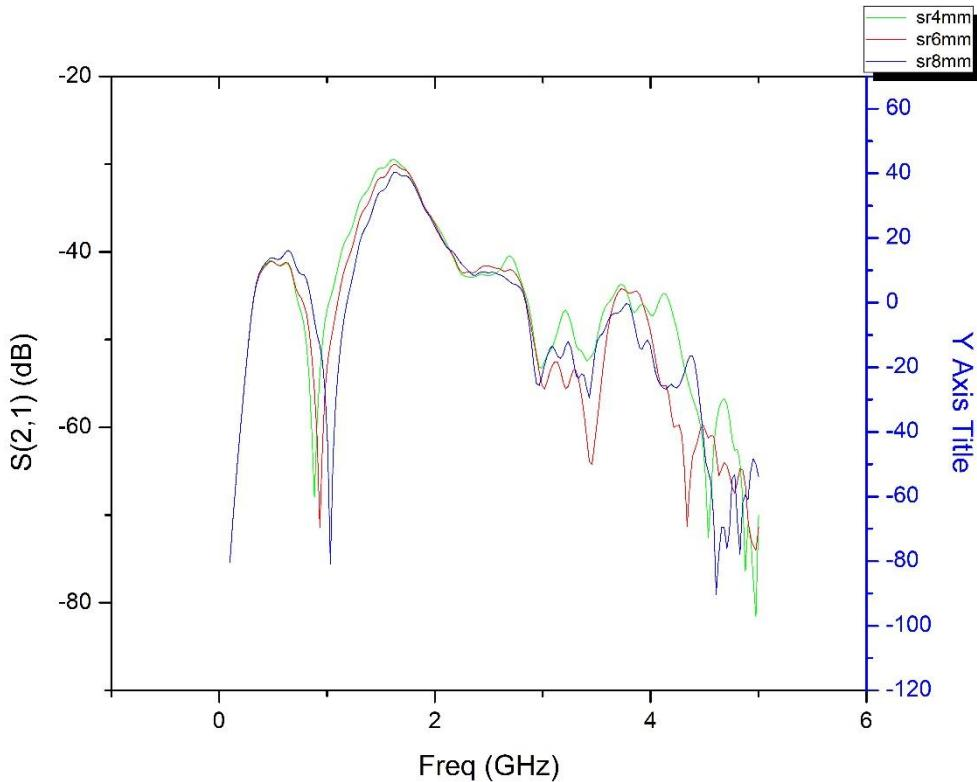
Slika 4.1. Simulacijski rezultati koeficijenta transmisije  $S_{21}$  za slučaj rezonatora za koji vrijedi:  $R_2 = 0.33R_1$  ( $R_1$  – radijus vanjskog prstena);  $R_2$  – radijus unutarnjeg prstena; sr – debljina prstena).
