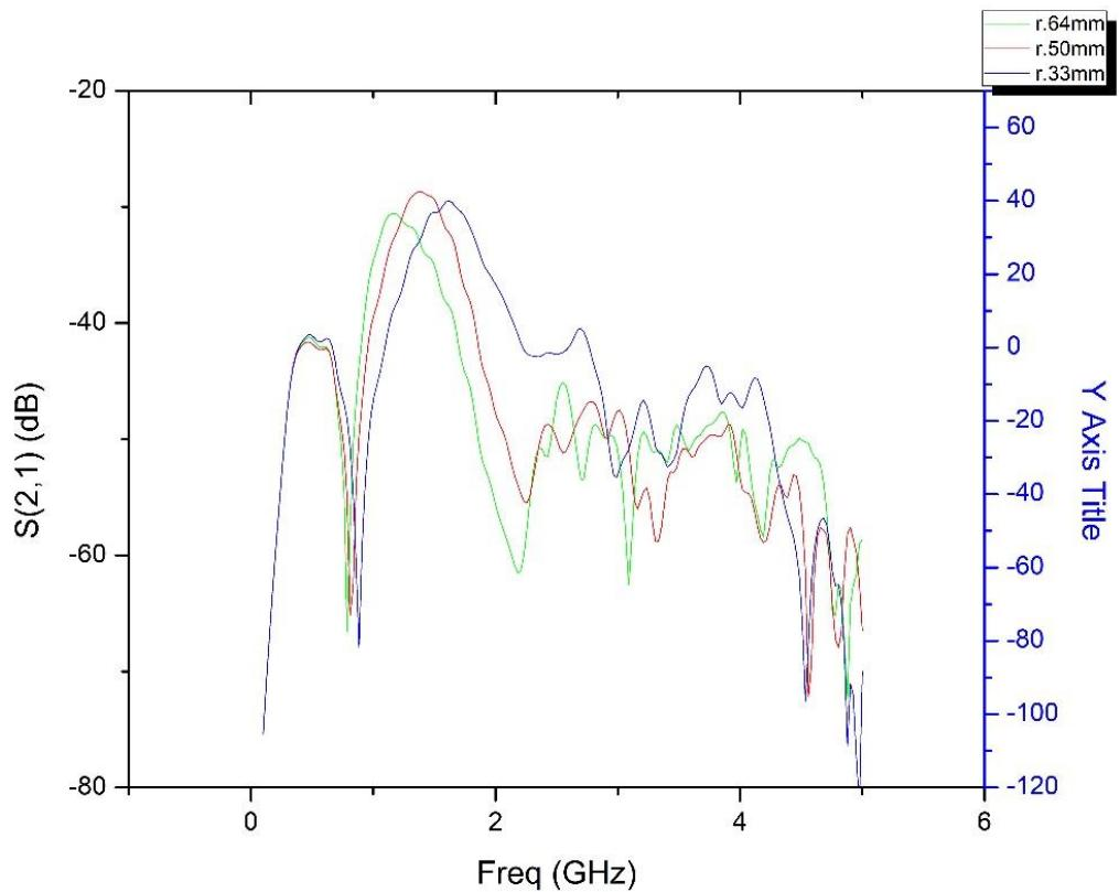
Slika 4.4. Simulacijski rezultati koeficijenta transmisije  $S_{21}$  za slučaj rezonatora za koji da je širina prstena 4mm.
