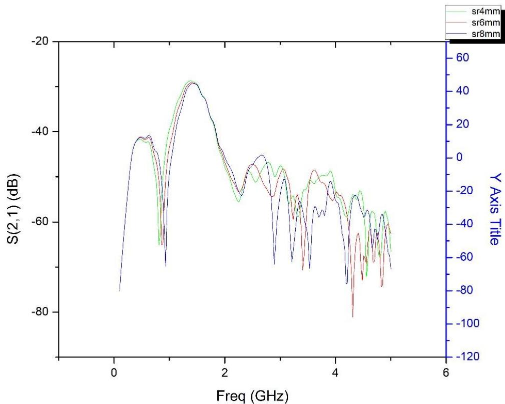
Slika 4.2. Simulacijski rezultati koeficijenta transmisije  $S_{21}$  za slučaj rezonatora za koji vrijedi:  $R_2 = 0.50R_1$  ( $R_1$  – radijus vanjskog prstena);  $R_2$  – radijus unutarnjeg prstena;  $sr$  – debljina prstena).
