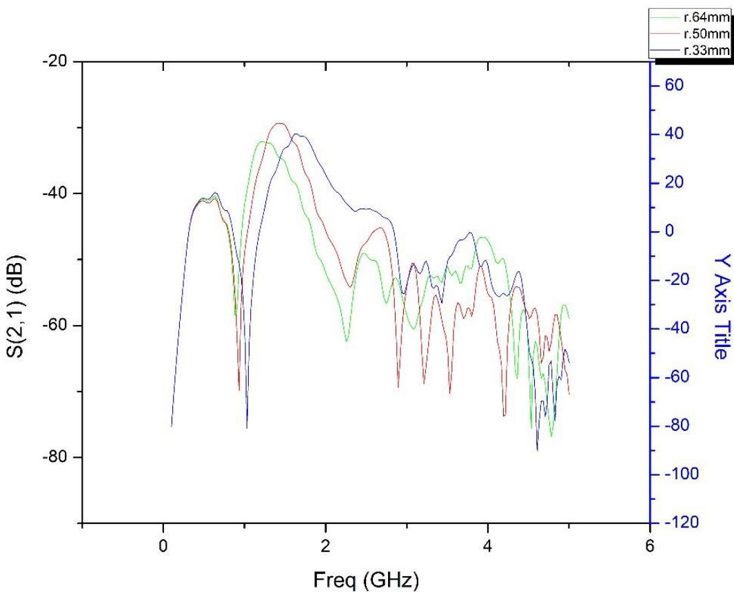
Slika 4.6. Simulacijski rezultati koeficijenta transmisije S<sub>21</sub> za slučaj rezonatora za koji da je širina prstena 8mm.
