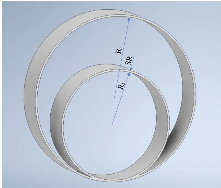
Slika 3.2.1. Mikrovalni rezonator s dva prstena radijus  $R_1$  i  $R_2$  te debeljinom prstena  $SR$
