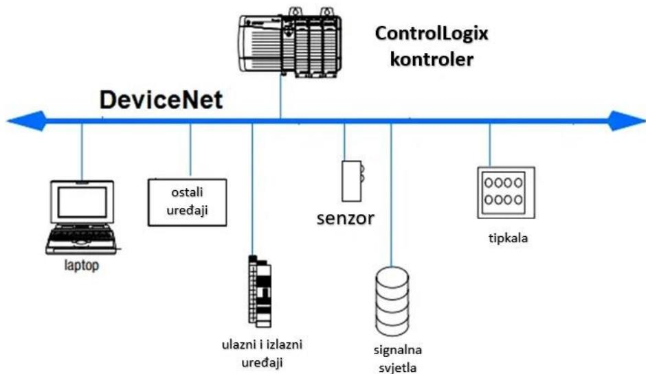
Slika 4.5. Arhitektura ControlLogix PLC uređaja
