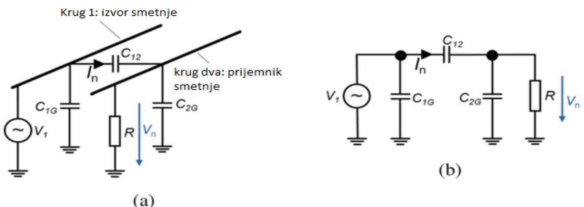
Slika 3.1. Prikaz kapacitivnog sprezanja[4]
