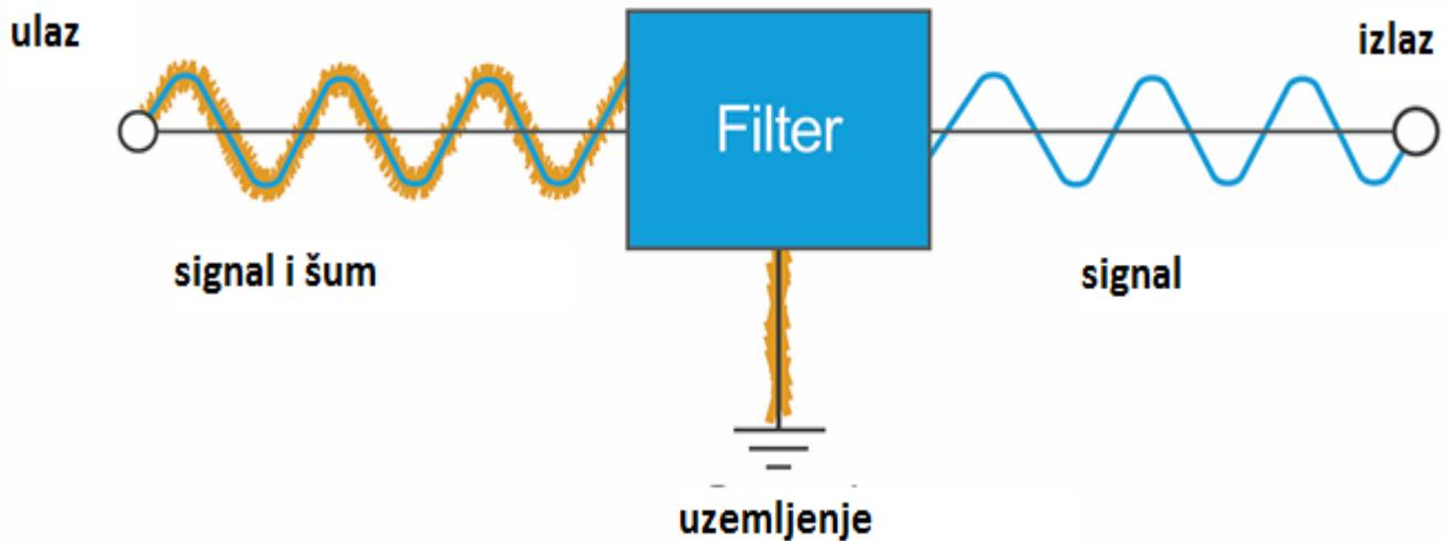
Slika 5.5 Pojednostavljeni prikaz filtera šuma[6]
